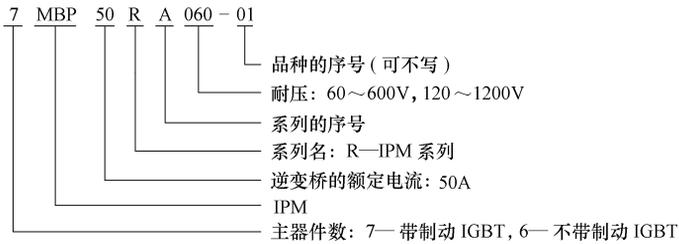
图 1-13 富士智能电力模块 IPM 型号含义
