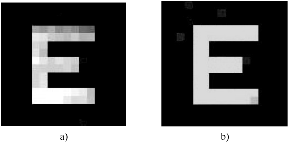
图 16.24 使用 sinc “陡降”校正前后的灰度图的计算机重构图像
