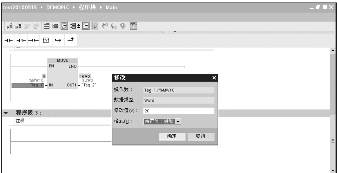
图 4-29 通过程序状态监视修改变量值
