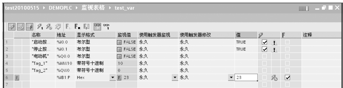
图 4-31 使用触发器修改
