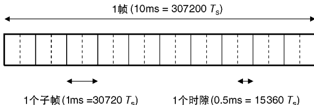
图 6.5 帧结构类型 1, 用于 FDD 模式 (资料来源: TS 36.211。经 ETSI 许可转载)
