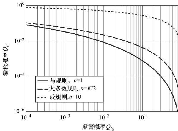
图 2.7 SNR = 10dB 和  $K = 10$  的衰落信道不同融合规则下集中式协同频谱感知的性能
