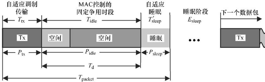
图 3.11 自适应调制模式自适应睡眠的能耗
