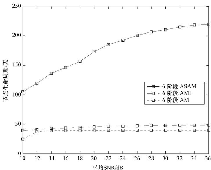
图 3.12 节点生命周期仿真：对数正态分布阴影信道六阶段 ASAM、AMI 和 AM 的比较 ( $\sigma = 2\text{dB}$ )
