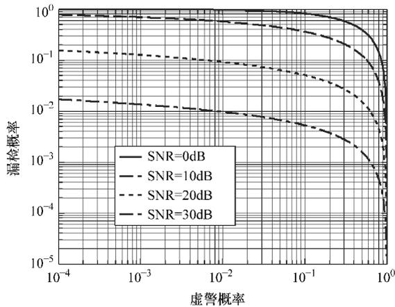
图 2.5 能量检测器在 SNR = 0dB、10dB、20dB 和 30dB 的瑞利衰落信道中的性能
