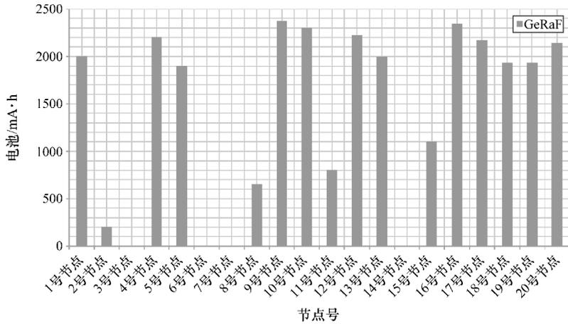
图 5.48 100 天后 GeRaF 协议电池消耗的电量
