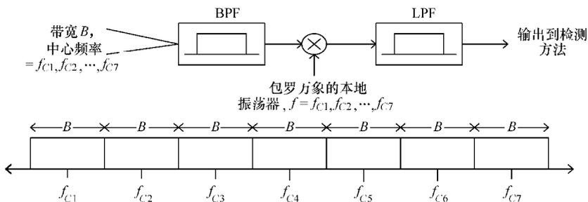
图 2.8 使用扫描电路的宽带频谱感知
