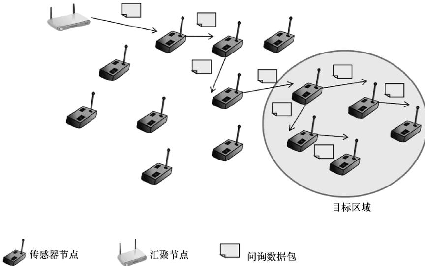
图 5.4 GEAR 协议：问询数据包转发至目标区域
