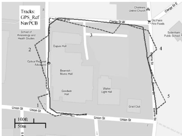
图 7.13 区域测试 II (A) : 5 次 GPS 运行中断情况下 GPS 轨道与车内轨道比较
