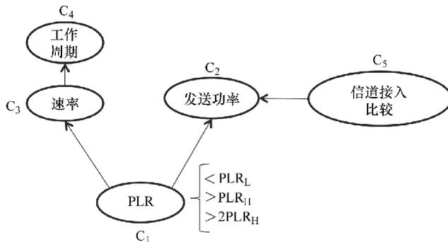
图 6.4 加权认知图发送功率、数据速率和工作周期自适应
