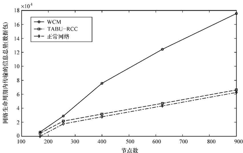
图 6.18 在瓶颈路径中 WCM 的信息传输能力
