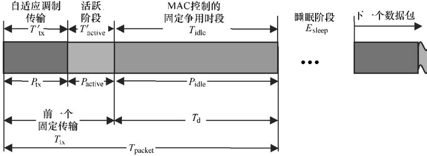
图 3.9 自适应调制模式的能耗
