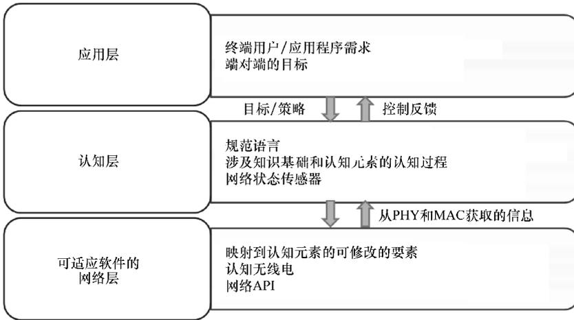
图 1.3 认知网络架构的例子
