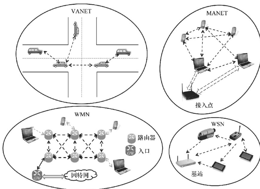
图 4.1 无线多跳网络的例子
