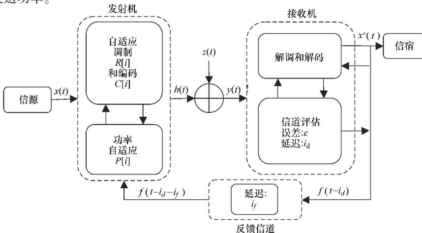
图 3.2 自适应反馈系统模型
