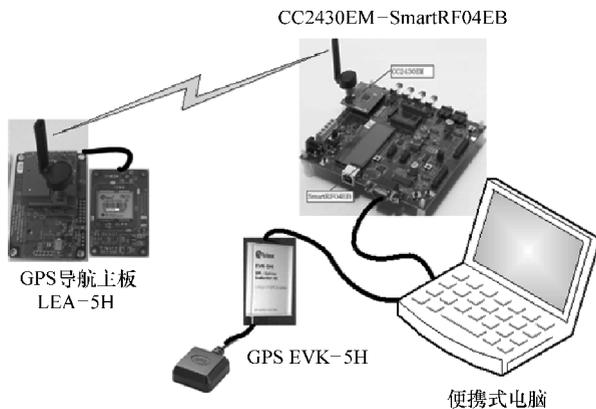
图 7.8 区域测试 II 的设备安装
