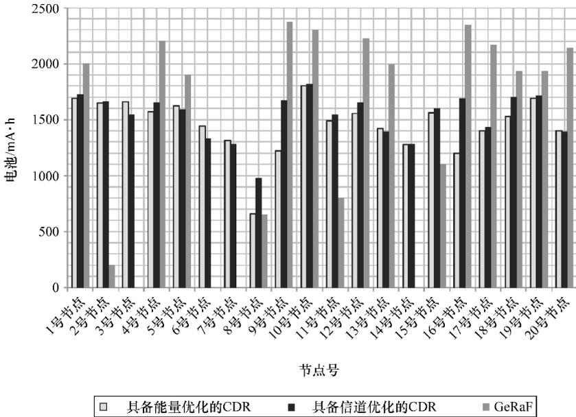
图 5.45 100 天后电池电量分布协议比较
