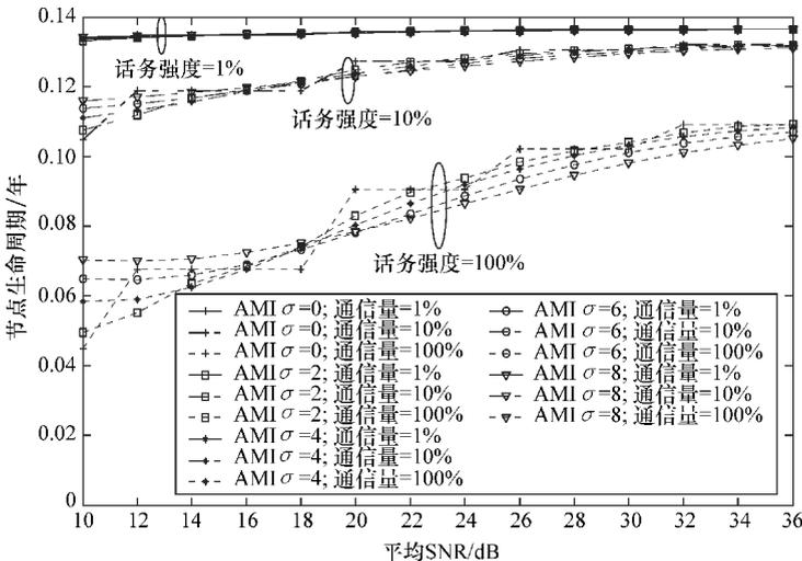
图 3.18 对数正态分布阴影信道使用 AMI 算法话务强度对节点生命周期的影响 (信道通信量为负载量的 1%、10% 和 100%)
