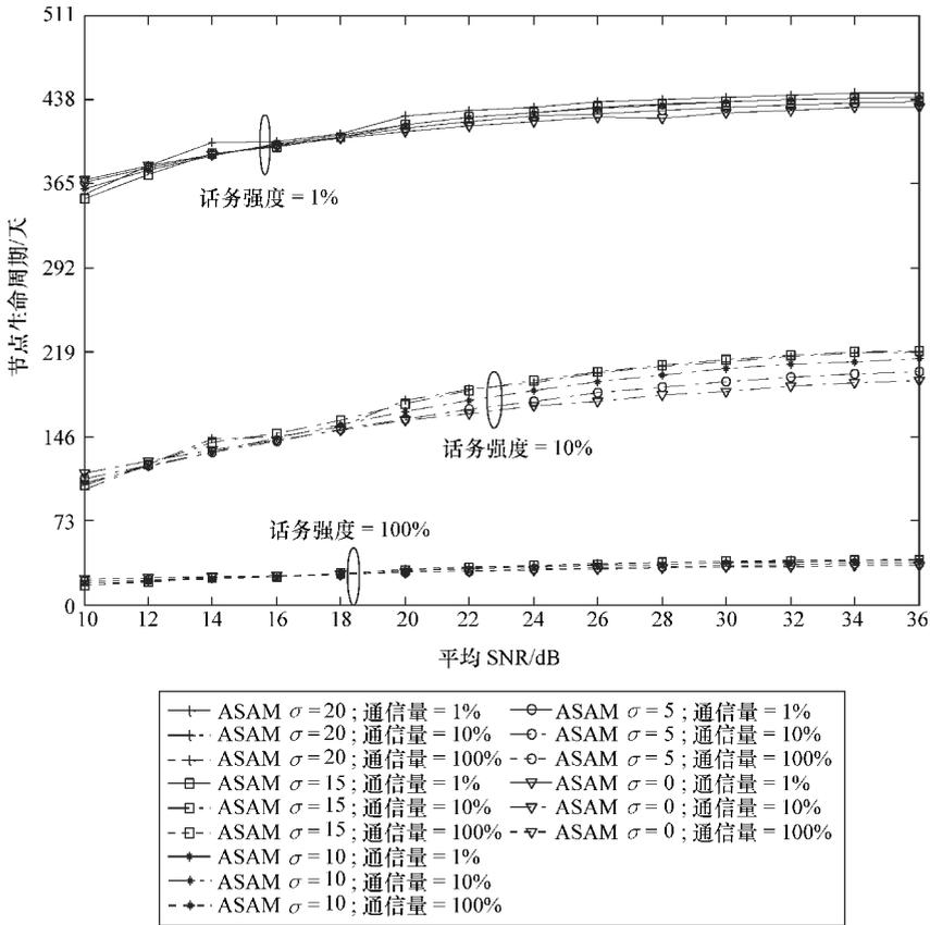
图 3.21 莱斯衰落信道使用 ASAM 算法话务强度对节点生命周期的影响 (信道通信量为负载量的 1%、10% 和 100%)
