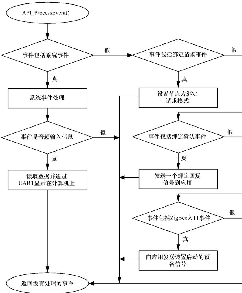
图 7.6 汇聚节点任务事件处理器的事件处理流程
