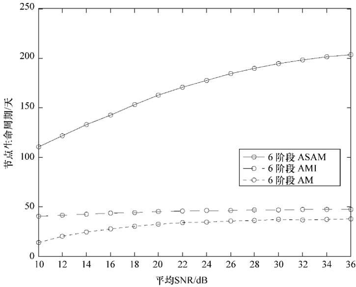
图 3.13 节点生命周期仿真：莱斯衰落信道六阶段 ASAM、AMI 和 AM 的比较 ( $K=5\text{dB}$ )
