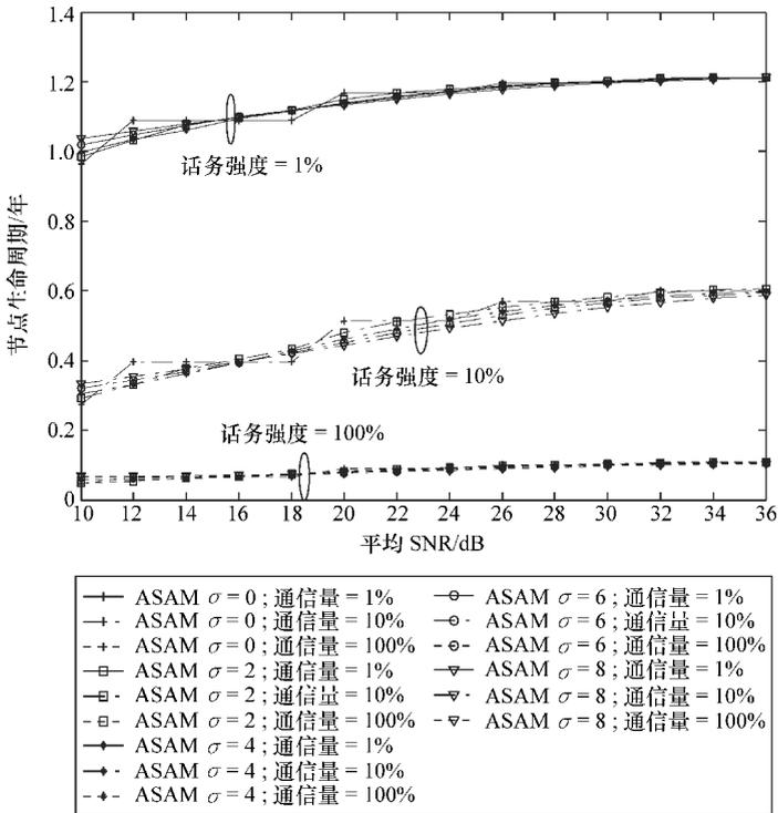
图 3.20 对数正态分布阴影信道使用 ASAM 算法话务强度对节点生命周期的影响
