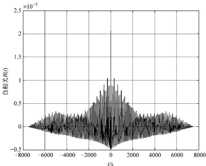
图 7.9 消除了偏置补偿后, 两个小时固定数据集  $x$  轴加速度计读数的自相关 (使用因子 1000 进行下采样)
