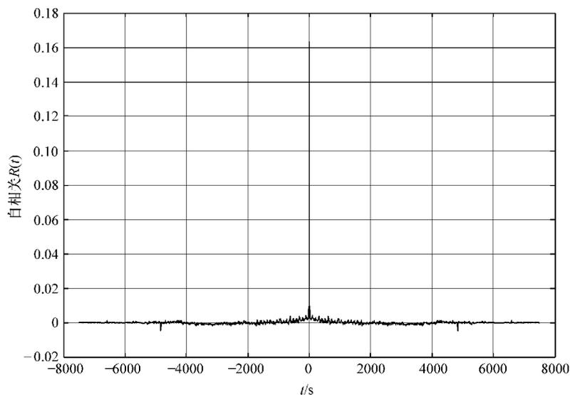
图 7.11 消除了偏置补偿后,两个小时固定数据集  $z$  轴加速度计读数的自相关 (使用因子 1000 进行下采样)
