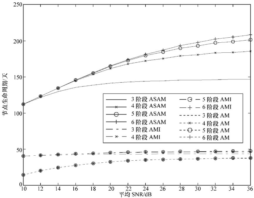
图 3.23 莱斯衰落信道使用 ASAM、AMI 和 AM 调制阶段对节点生命周期的影响 ( $K = 5\text{dB}$ )
