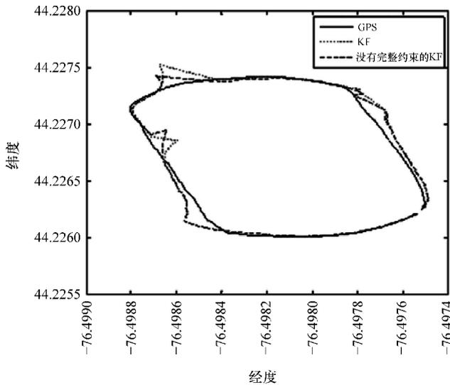
图 7.12 4 次 GPS 运行中断情况下 GPS 轨道与 KF 轨道的对比
