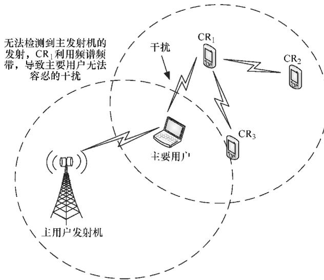
图 2.4 CR 系统隐藏的 PU 问题示意图
