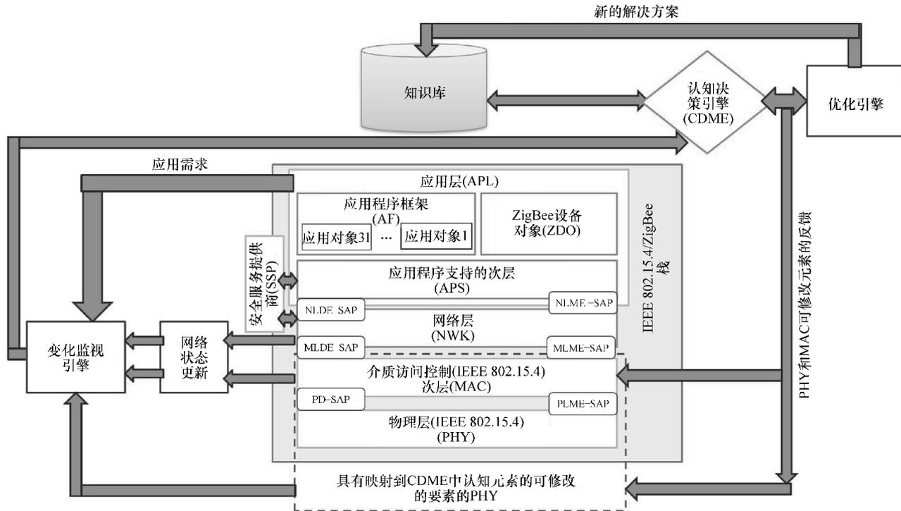
图 1.4 认知节点架构
