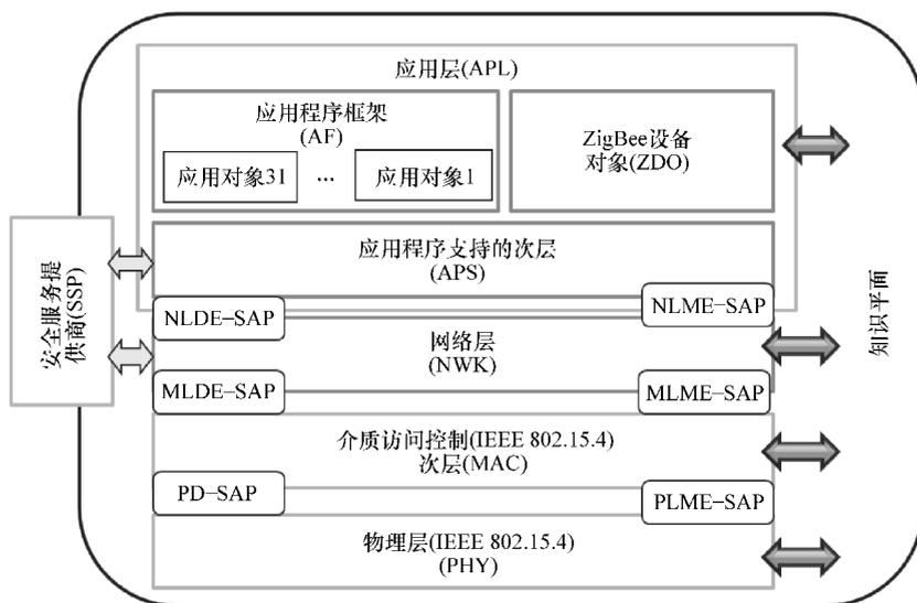
图 1.2 WSN 协议栈的知识平面
