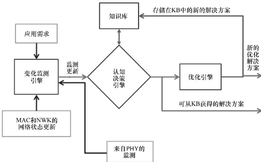
图 1.6 增强的协议栈的各个块之间相互作用的简化框图
