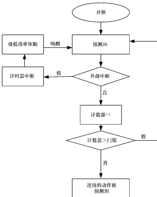
图 7.3 运动探测流程图
