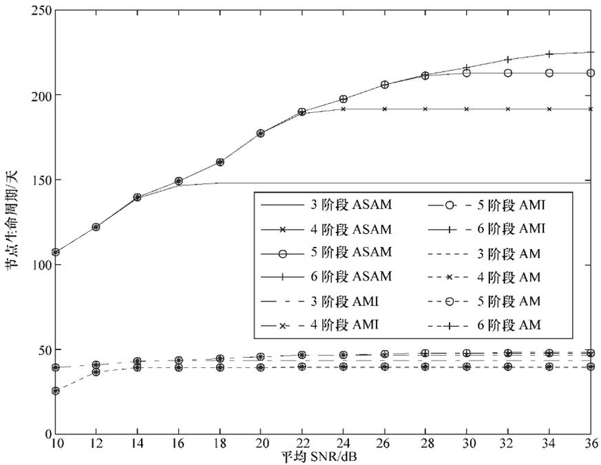
图 3.22 对数正态分布阴影信道使用 ASAM、AMI 和 AM 调制阶段对节点生命周期的影响 ( $\sigma = 2\text{dB}$ )
