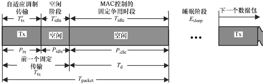
图 3.10 空闲模式自适应调制的能耗
