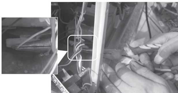
图 4-63 拔掉高压变压器一次侧插头
