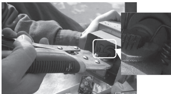
图 5-18 用铁钳将焊点啮合
