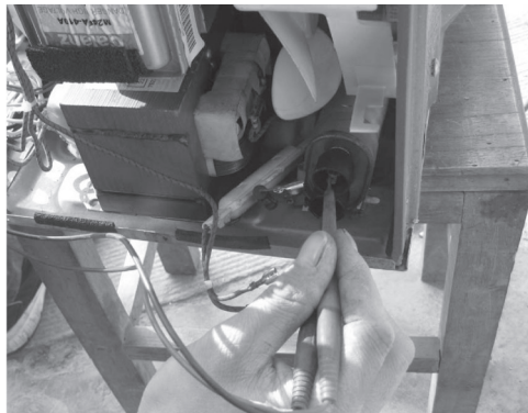
图 5-37 检查高压电容器
