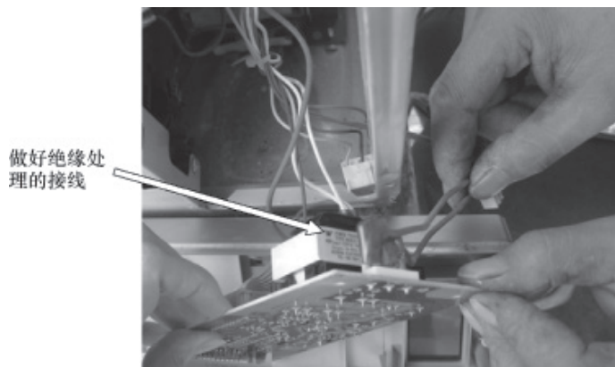
图 3-84 操作电路板的供电处理
