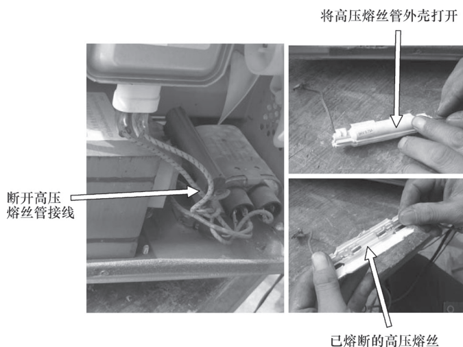
图 4-73 更换高压熔丝
