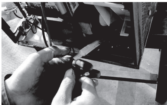
图 5-46 将高压变压器与高压电容器连接线拔下
