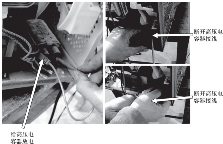
图 5-52 给高压电容器放电
