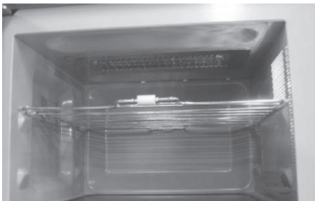
图 3-67 微波炉烧烤器的固定位置
