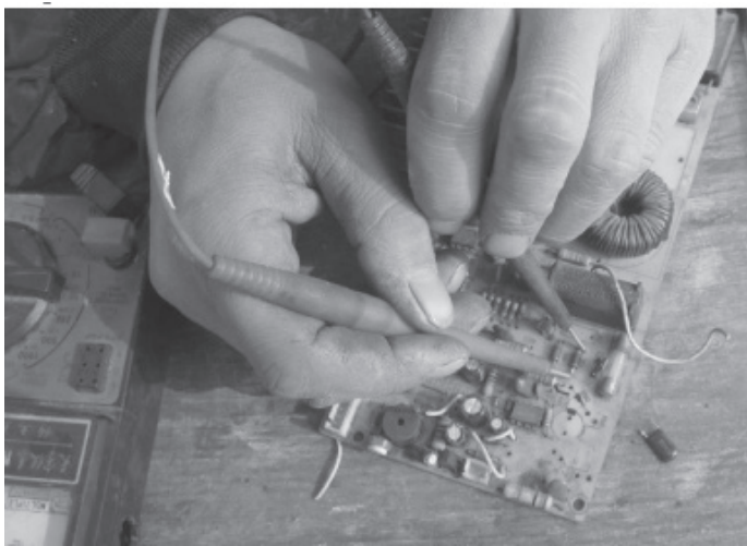
图 2-55 第二次测量二极管
