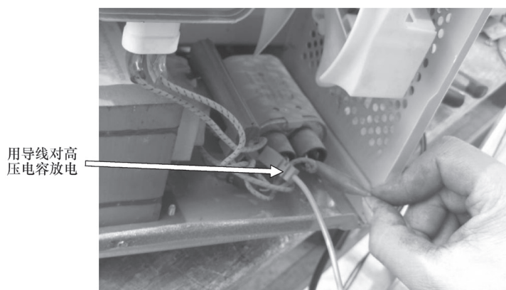
图 4-65 对高压电容放电
