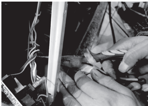
图 5-11 拔掉高压变压器一次绕组插头
