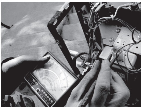
图 5-15 检测磁控管的灯丝间电阻
