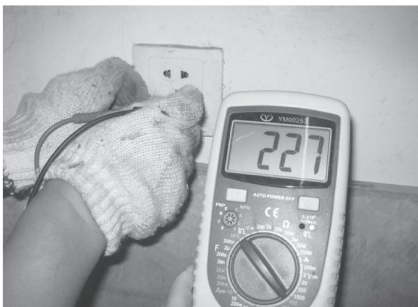
图 4-27 检测插座输入电源正常
