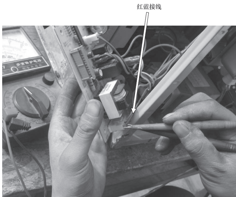
图 4-21 检查电源输入的电压
