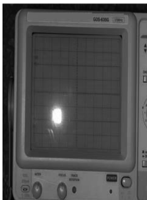
图1-15 示波器荧屏显示区外形结构
