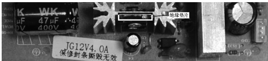
图 3-22 绝缘垫片的位置
