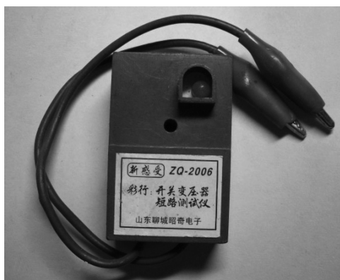
图 1-24 开关电源开关变压器短路专用测试仪实物图
