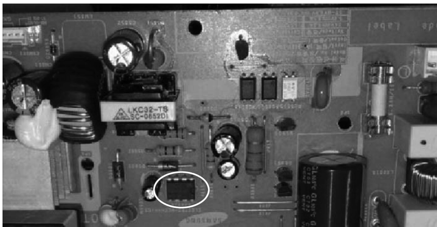
图 2-21 液晶电视开关电源用电源管理 IC
