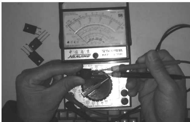
图 2-32 发射极和集电极反测电阻
