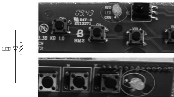
图 2-17 液晶电视开关电源用发光二极管及电路符号
