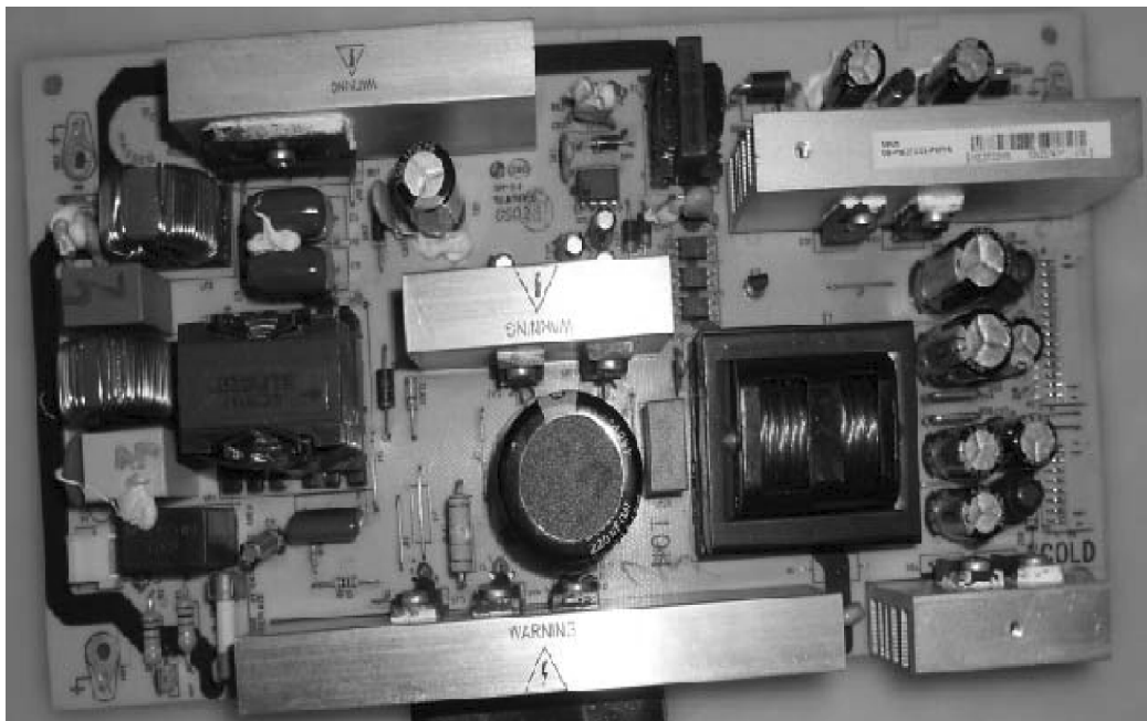
图 5-24 电源板 40-6PL37C-PWD1XG 实物板图
