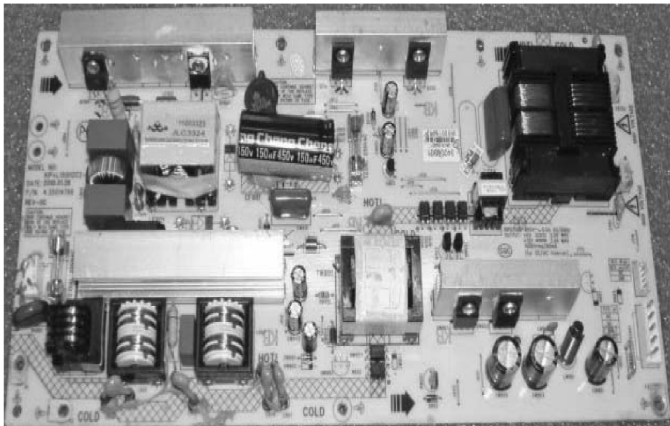
图 5-120 电源板 KIP + L150112C2 -01 实物板图
