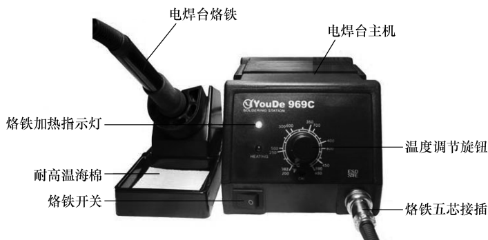
图 1-21 防静电焊台
