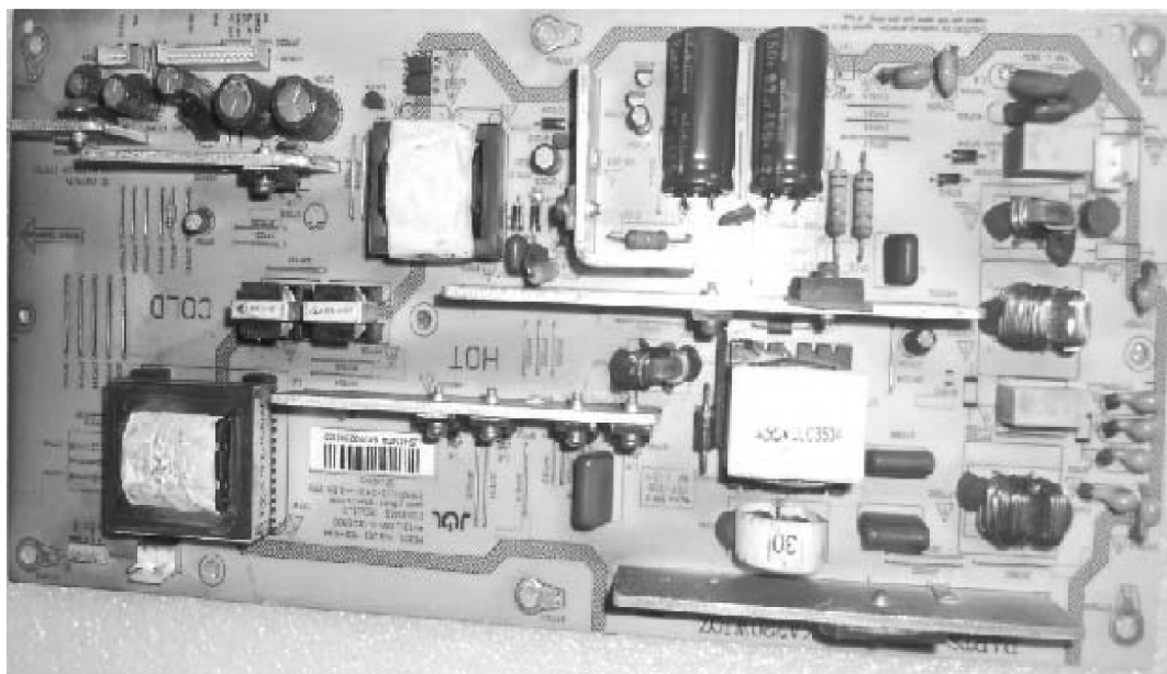
图 5-145 电源板 JSI-401403A 实物板图
