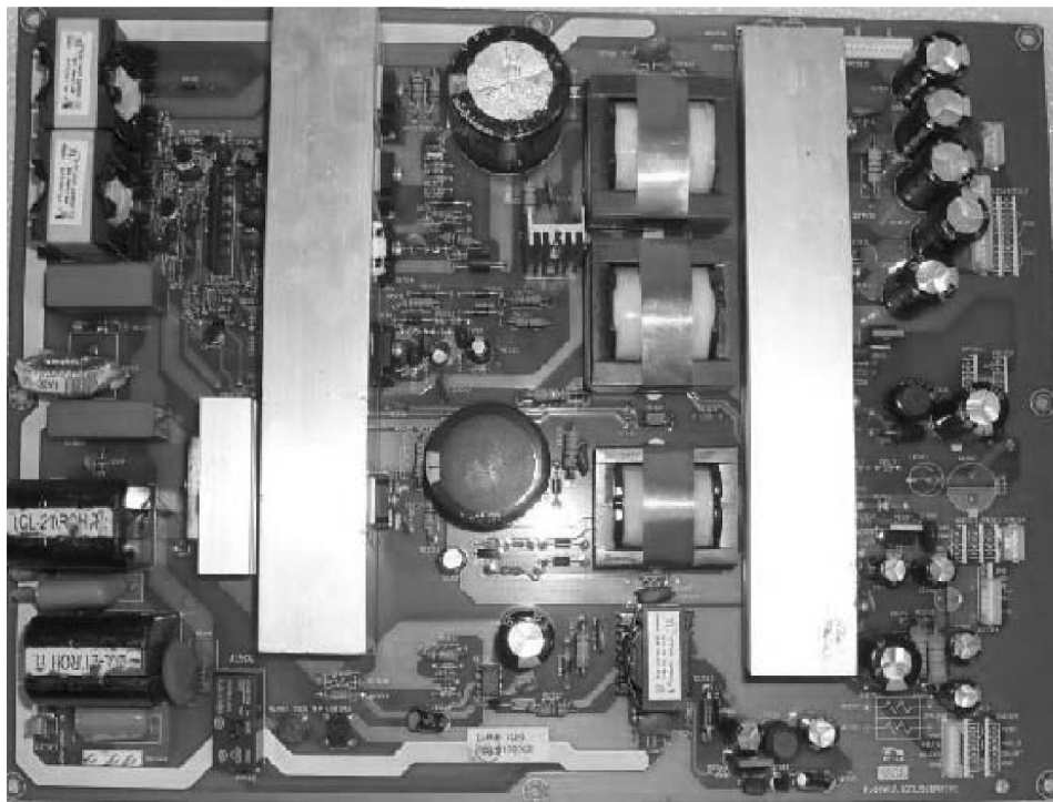
图 5-114 电源板 RSAG7.820.568A 实物板图
