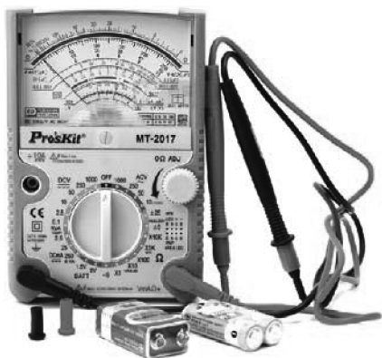
图 1-12 指针式万用表外形图
