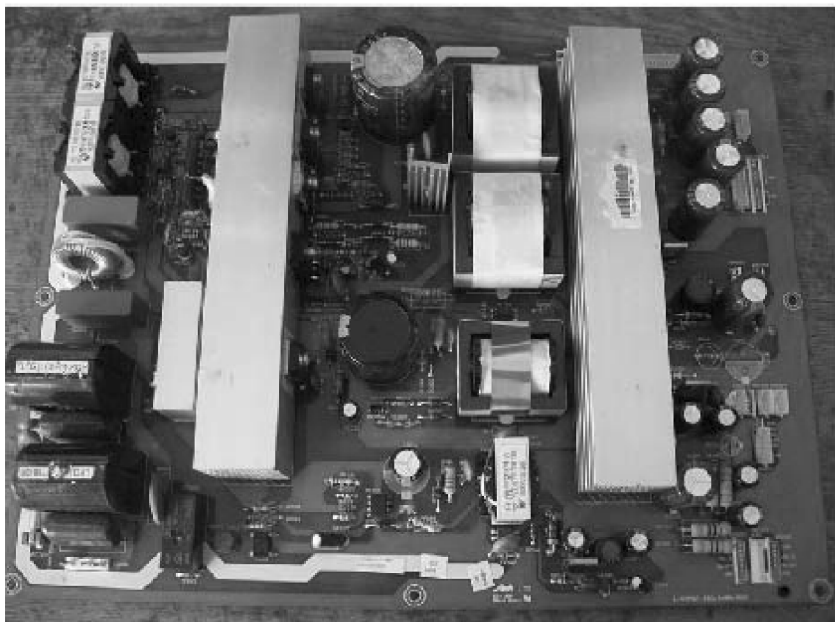
图 5-115 电源板 RSAG2.908.495 实物板图
