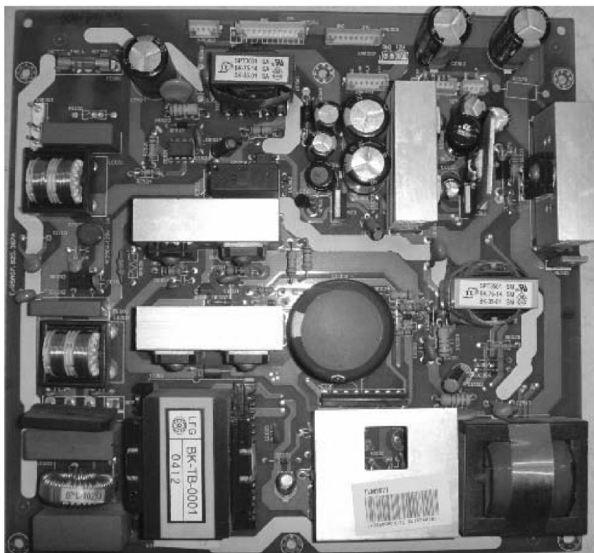
图 5-109 电源板 RSAG7.820.387A 实物板图
