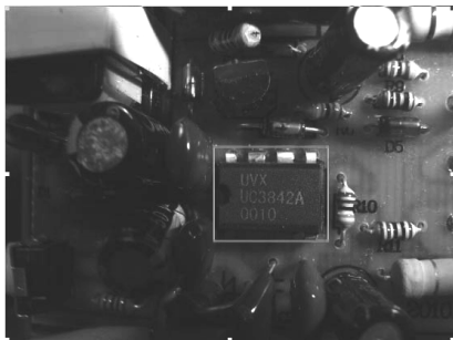
图 2-36 看厚膜块集成电路封装和字迹
