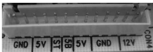
图 3-15 32 ~ 37in 液晶电视开关电源电源板输出插座
