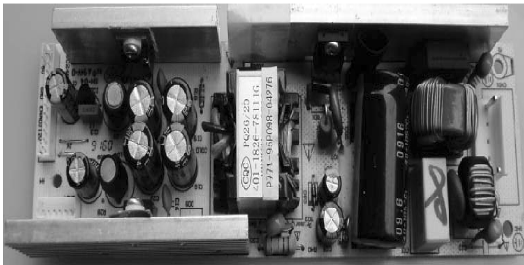
图 5-6 电源板 465-0103-17006G-A3 实物板图
