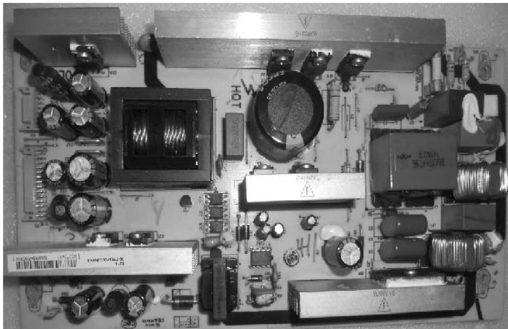
图 5-37 电源板 40-0PL37C-PWC1XG 实物板图
