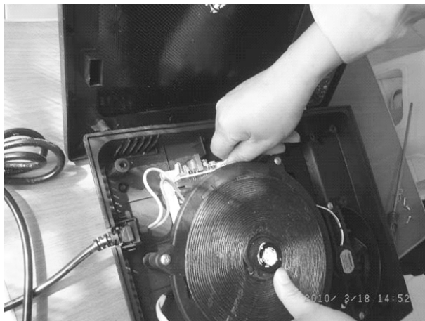
图 3-13 拔出上盖面板与主板之间的扁平连线（一）
