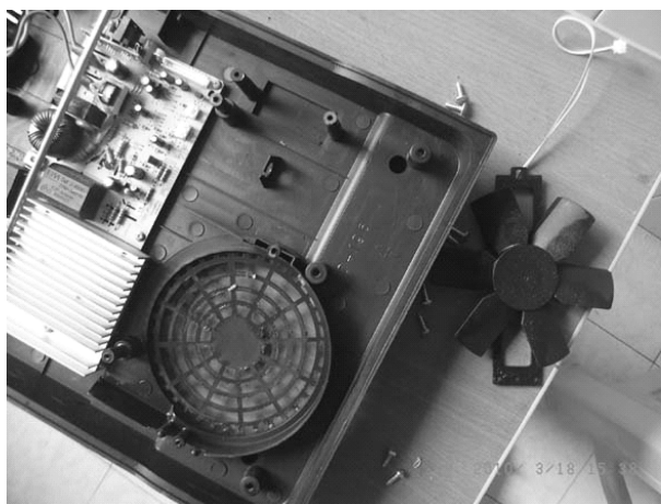
图 3-25 取下散热风扇
