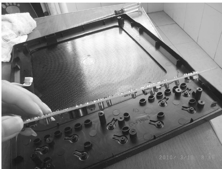
图 3-36 取下面板印制电路板（一）
