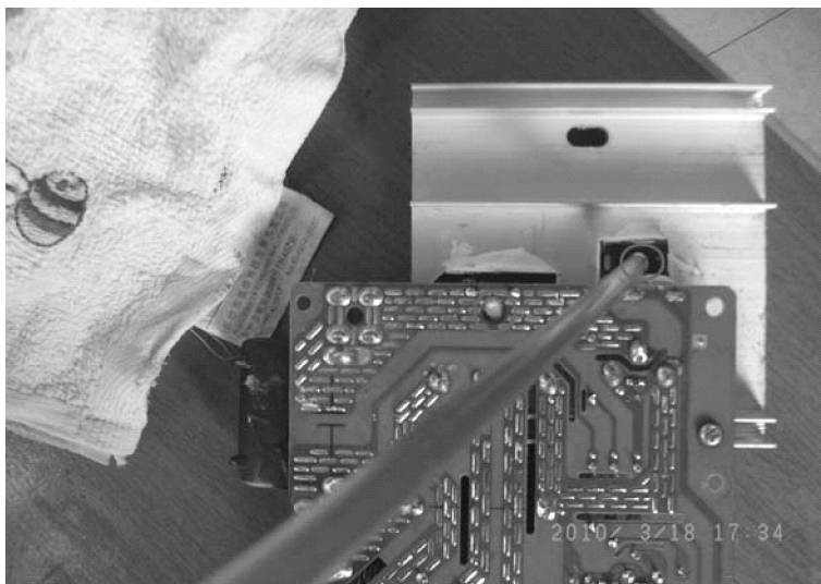
图 3-32 拆下 IGBT、整流桥的固定螺钉
