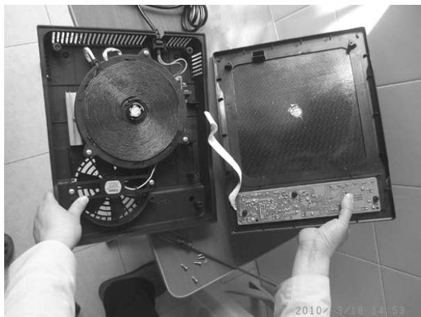
图 3-15 将电磁炉上、下盖分离
