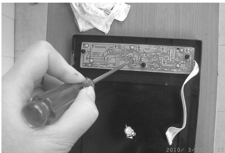
图 3-35 拆下面板印制电路板的固定螺钉
