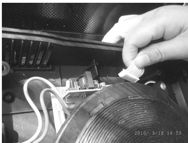
图 3-14 拔出上盖面板与主板之间的扁平连线（二）
