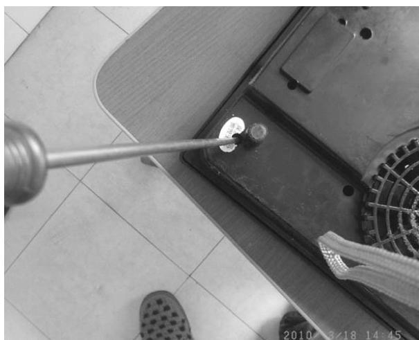
图 3-11 拆下保修标签下的固定螺钉
