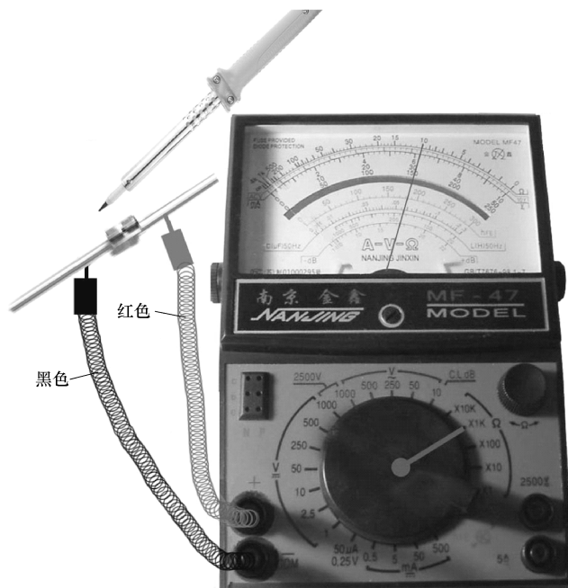
图 2-50 PTC（正温度系数）热敏电阻的加温检测
