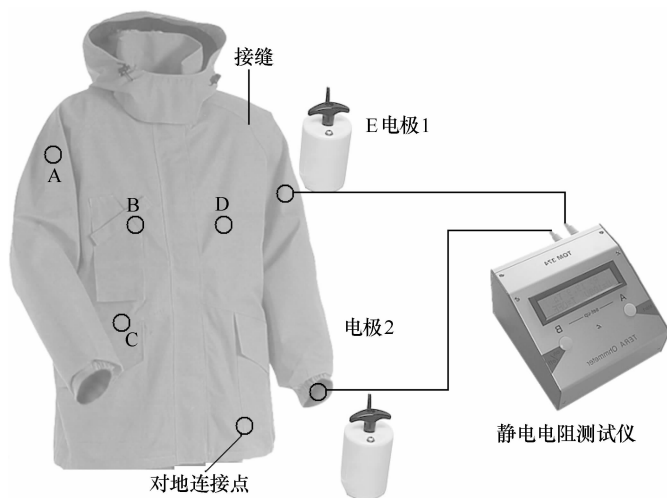
图 4-36 防静电工作服表面电阻（点对点）测试原理图
