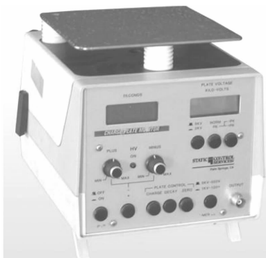
图 4-17 静电衰减时间测试
