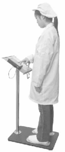
图 4-35 人体综合电阻的测试
