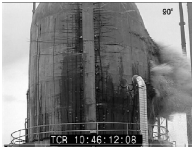
图 1-17 PCCV 比例模型的破坏试验
