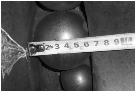
图 4-2 磨煤机内部筒体衬板与端衬板之间的缝隙中卡入了钢球(局部放大)
