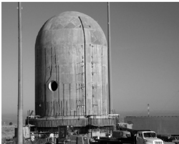
图 1-16 PCCV 按 1:4 比例缩小的模型
