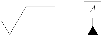
图 8-35 表面粗糙度符号和几何公差基准符号—图块练习
