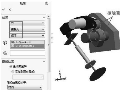
图8-96 设置【结果和图解】属性
