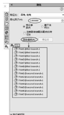
图 9-71 查找装配体中圆角和倒角
