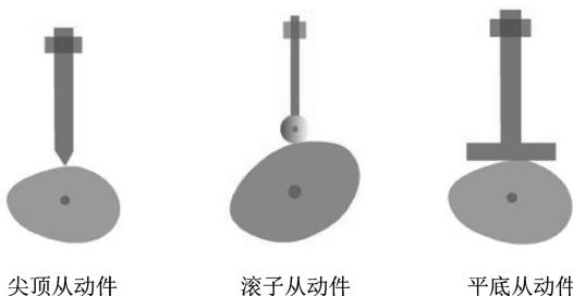
图 8-83 按从动件的形状进行分类的凸轮机构
