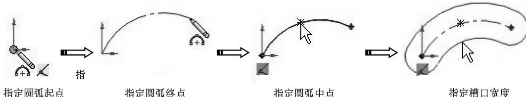
图 2-49 绘制 3 点圆弧槽口
