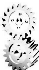
图 8-70 交错轴斜齿轮传动
