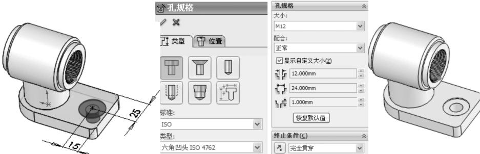
图 1-87 创建阀体底座的沉头孔
