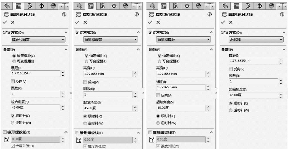
图 4-19 【螺旋线/涡状线】面板的 4 种螺旋线定义方式
