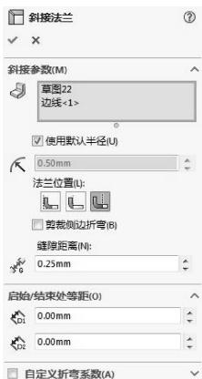
图 6-20 【斜接法兰】属性面板
