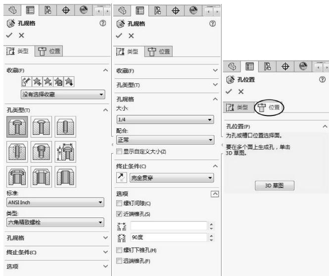
图 3-81 【孔规格】面板
