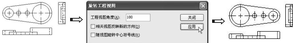
图 10-34 未勾选两个复选框的旋转视图结果
