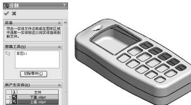
图 3-128 分割零件并生成新零件
