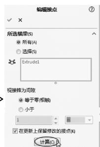
05 稍后会把计算结果显示在【结果】列表中，同时在模型上也显示接点，如图9-50所示。单击【确定】按钮 $\checkmark$ ，结束操作。
