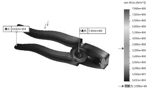
图 9-78 von Mises 应力图解
