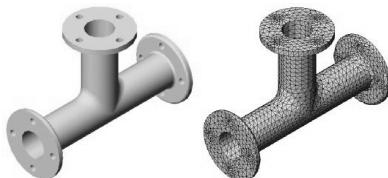
图 9-39 CAD 模型和 3D 四面实体单元
