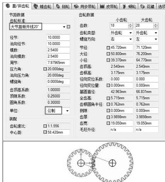
图 5-73 设置直齿轮参数
