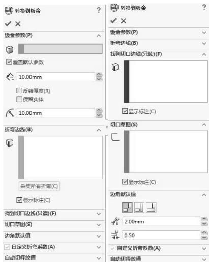
图 6-66 【转换到钣金】属性面板
