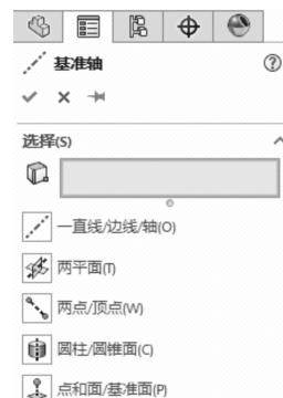
图 1-67 【基准轴】属性面板
