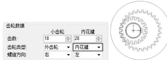
图 5-74 创建内啮合齿轮的设置
