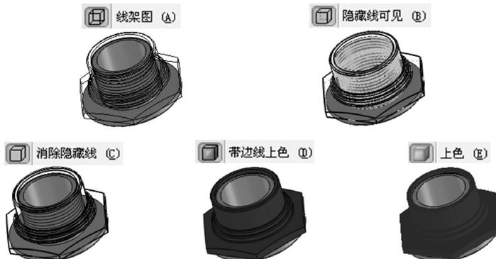
图 7-10 零部件的 5 种显示模式
