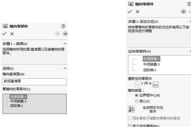
图 7-31 【镜像零部件】属性面板
