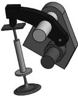
图 8-87 阀门凸轮机构
