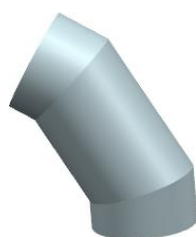
图 8.3.15 60° 三节圆形等径弯头
