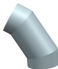
图 1.3.45 60° 三节圆形等径弯头
