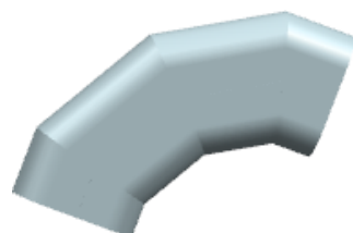
图 11.4.20 装配四节长圆形直角弯头
