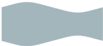
图 11.4.23 四节长圆形直角弯头中节 1 展开
