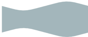
图 11.4.24 四节长圆形直角弯头中节 2 展开
