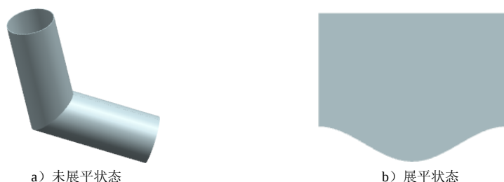
图 8.2.1 两节等径任意角弯头及其展开图样
