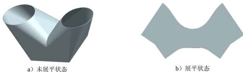
图 18.3.1 主方管分管 V 形三通及其展开图
