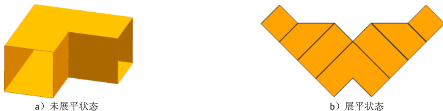
图 15.1.1 两节直角等径方形弯头及其展开图
