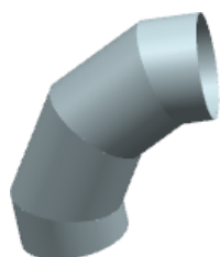
图 8.4.20 90° 四节圆形等径弯头
