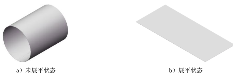
图 2.1.1 普通圆柱管及其展平图样
