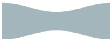
图 8.4.23 90° 四节圆形等径弯头中节 1 展开
