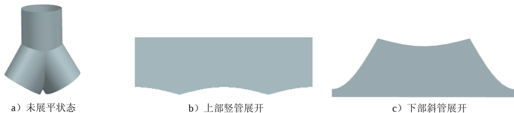
图 10.4.1 等径圆管 Y 形三通及其展平图样
