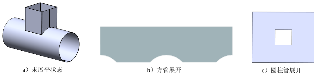
图 18.1.1 圆管方管直交三通及其展开图
