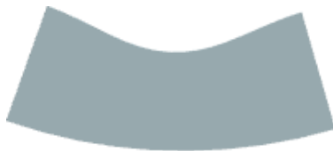
图 9.2.20 75° 三节渐缩弯头底部圆锥管展开
