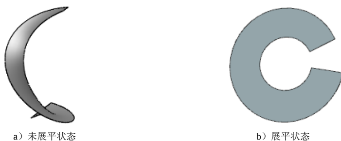
图 21.2.1 圆柱不等宽渐缩螺旋叶片及其展平图样
