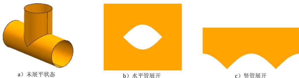
图 10.1.1 等径圆管直交三通及其展平图样
