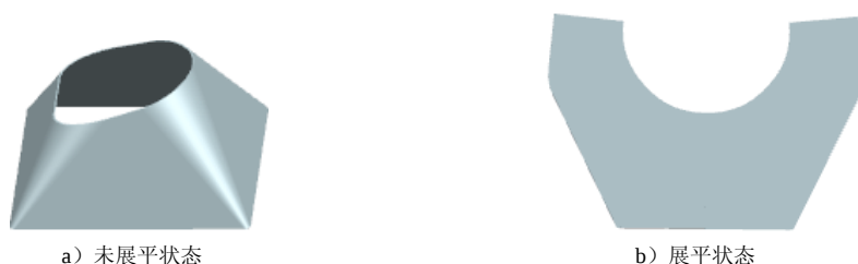
图 17.6.1 圆口倾斜天圆地方及其展开图
