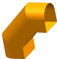
图 11.1.14 装配三节拱形直角弯头
