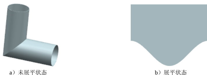
图 8.1.1 两节等径直角弯头及其展平图样
