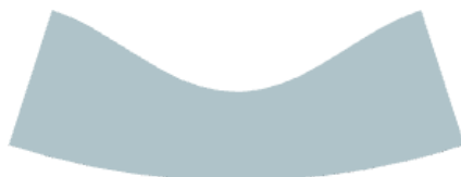
图 9.3.20 90° 三节渐缩弯头底部圆锥管展开
