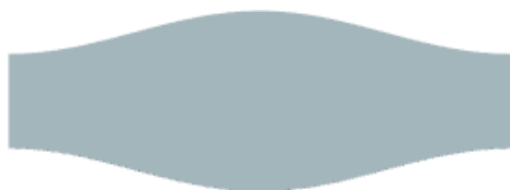
图 8.4.24 90° 四节圆形等径弯头中节 2 展开
