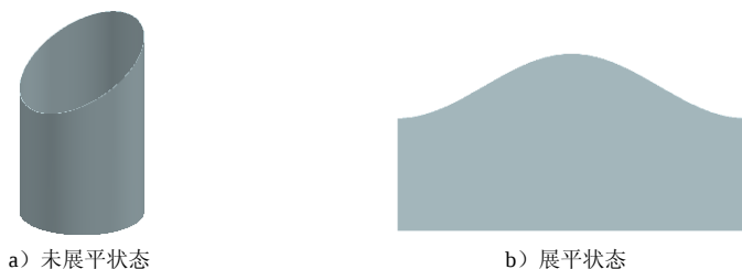
图 1.3.1 斜截圆柱管及其展开图样
