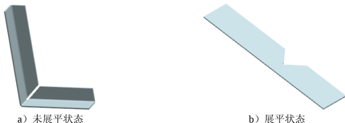
图 22.1.1 90^\circ 内折角钢及其展开图样
