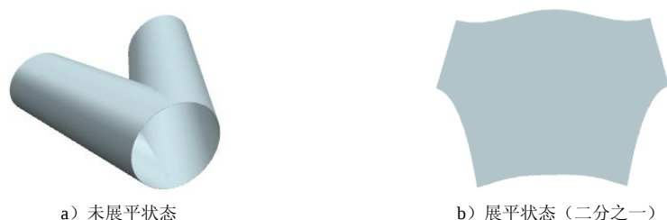
图 10.6.1 变径圆管 V 形三通及其展平图样
