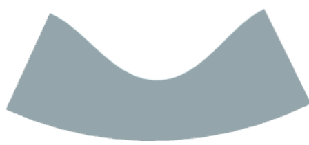
图 9.1.14 60° 两节渐缩弯头上部圆锥管展开
