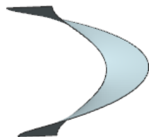
图 21.2.5 圆柱不等宽渐缩螺旋叶片钣金件
