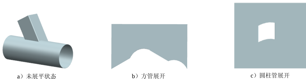
图 19.5.1 方管斜交偏心圆管三通及其展开图
