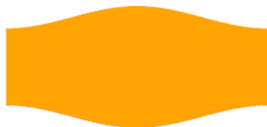
图 1.3.48 60° 三节圆形等径弯头中节展开
