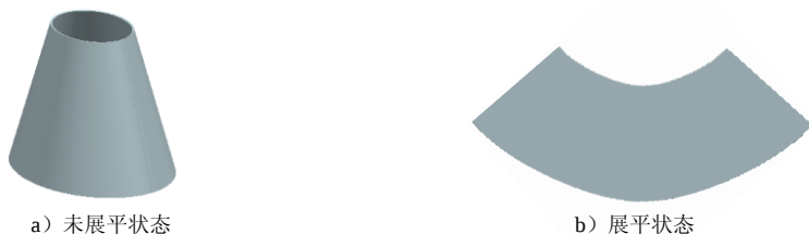
图 5.1.1 平口正椭圆锥台管及其展开图样
