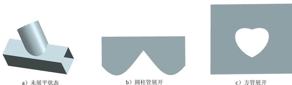
图 19.8.1 圆管斜交方形三通及其展开图
