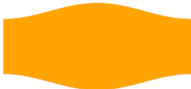
图 8.3.18 60° 三节圆形等径弯头中节展开
