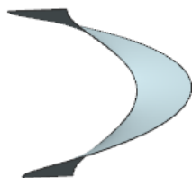
图 21.3.5 圆锥等宽渐缩螺旋叶片钣金件
