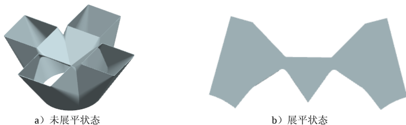
图 18.5.1 主圆管分异径方管放射形五通及其展开图
