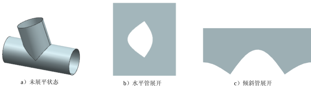
图 10.2.1 等径圆管斜交三通及其展平图样
