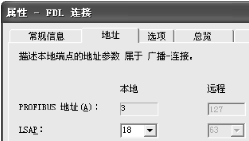
图 4-54 3 号站的 FDL 连接的地址信息
