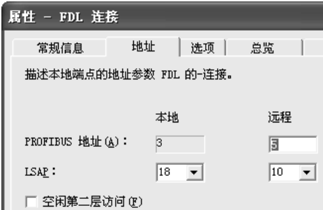
图 4-41 3 号站的 FDL 连接的地址信息
