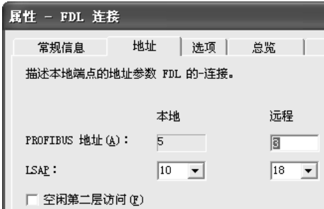
图 4-42 5 号站的 FDL 连接的地址信息
