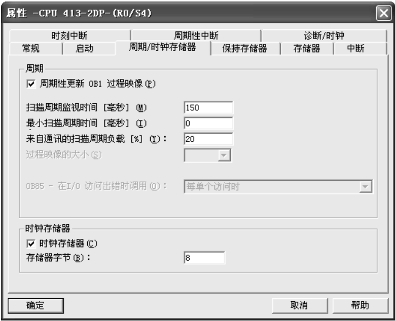
图 4-5 设置时钟存储器
