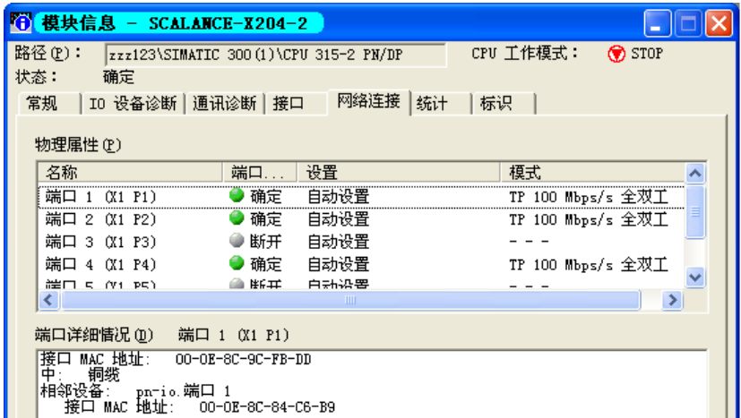
图 11-16 X204-2 的模块信息对话框
