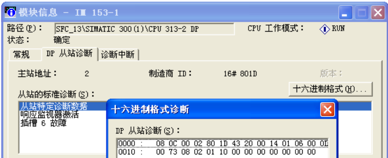
图 7-5 IM 153-1 的模块信息对话框
