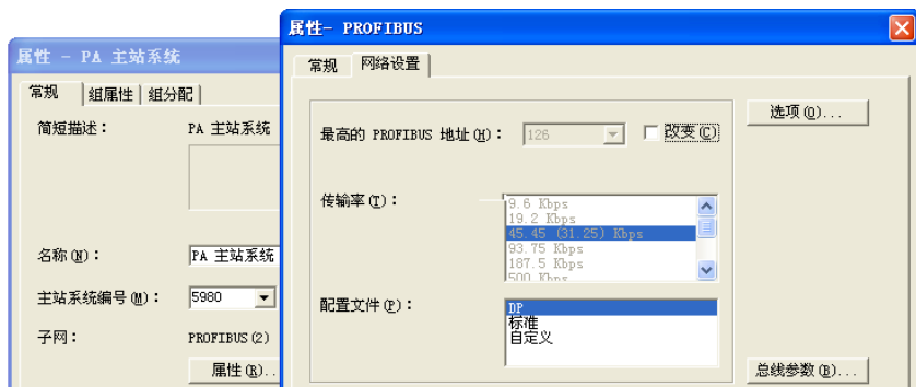
图 9-7 PA 主站系统属性对话框
