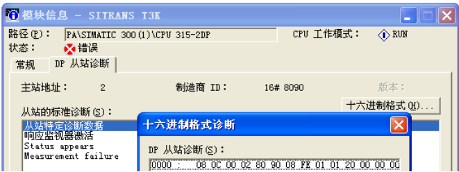
图 9-25 T3K 的模块信息对话框
