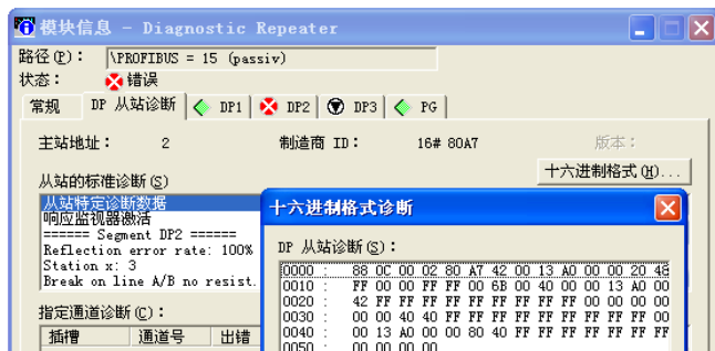
图 6-53 诊断中继器的模块信息
