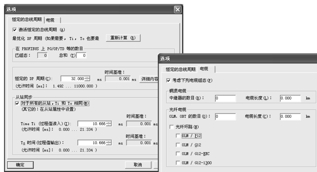
图 3-7 PROFIBUS 网络选项对话框
