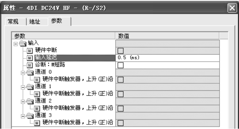
图 5-43 设置数字量输入模块的输入延迟时间
