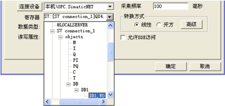
图 13-30 定义变量 DB1.DBW0
