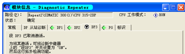
图 6-51 诊断中继器的模块信息
