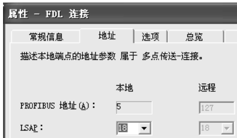
图 4-60 5 号站的 FDL 连接的地址信息
