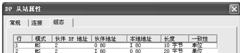
图 5-6 组态 3 号从站的通信 I/O 区
