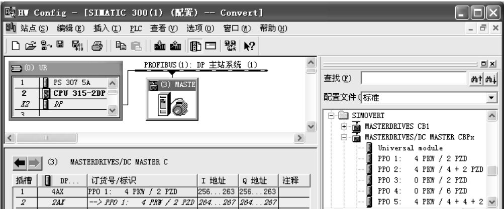
图 3-34 组态 DP 网络中的变频器
