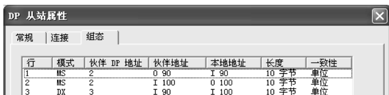
图 5-7 组态 4 号从站的通信 I/O 区
