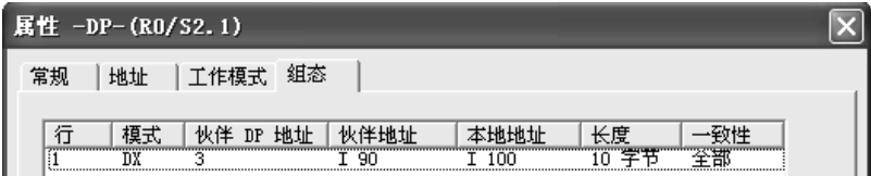
图 5-20 组态 4 号主站的通信 I/O 区
