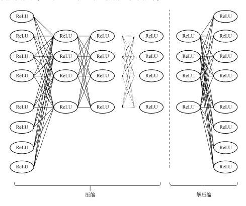
图 2.4 Jeong 和 Hussain 的图像压缩 DNN ReLU—修正的线性单元
