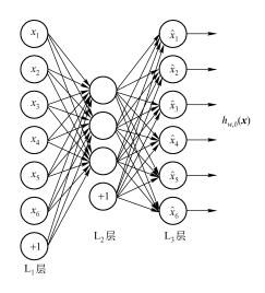
图 5.4 基本 AE 结构
