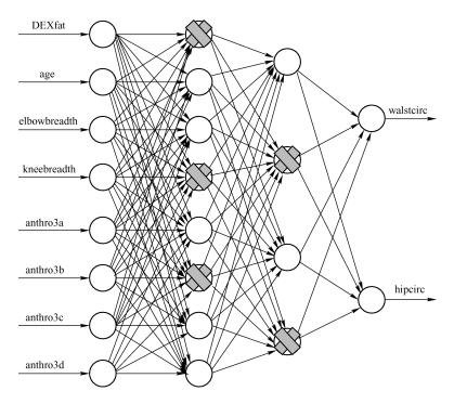
图 2.9 DNN Dropout 策略
