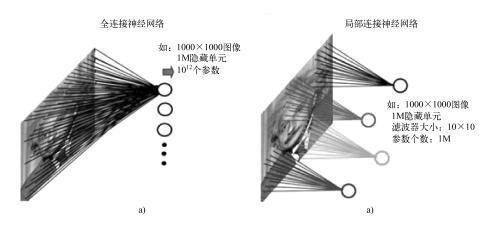
图 3.1 CNN 结构
