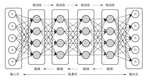
图 6.6 由 4 个隐藏层构造的堆栈降噪自编码网络
