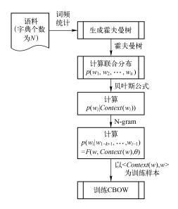
图 10.6 word2vec 算法流程
