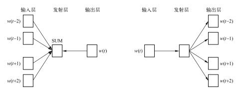
图 10.2 CBOW 模型结构
