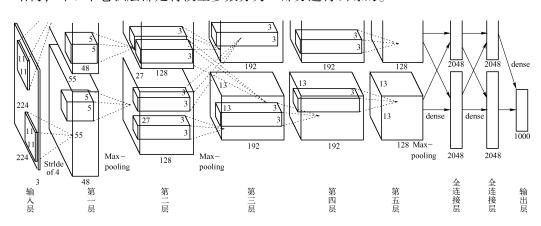
图 3.6 Alex 的 CNN 结构图
