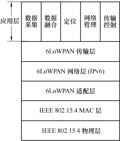
图 4-4 6LoWPAN 协议的体系结构
