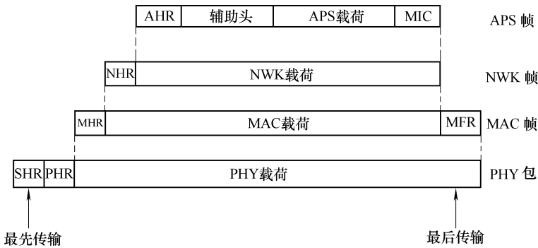
图 3-9 ZigBee 的包结构
