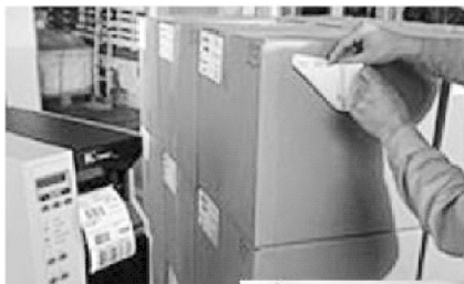
图 5-13 贴放 RFID 标签
