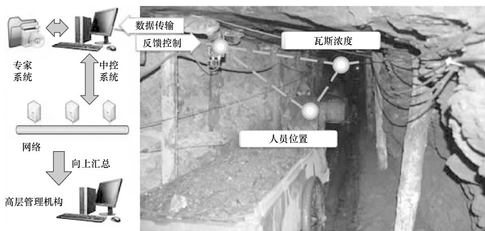
图 5-15 井下环境监测系统技术架构
