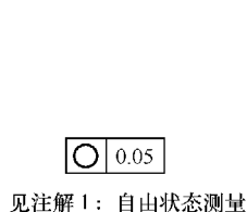
图 4-29 圆度的自由测量定义方式
