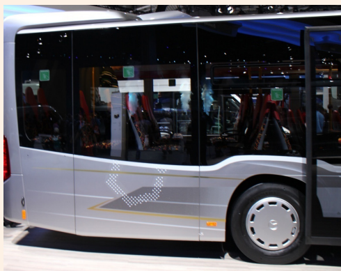
图 3-30 BENZ 的公交车侧蒙皮分段结构（二）
