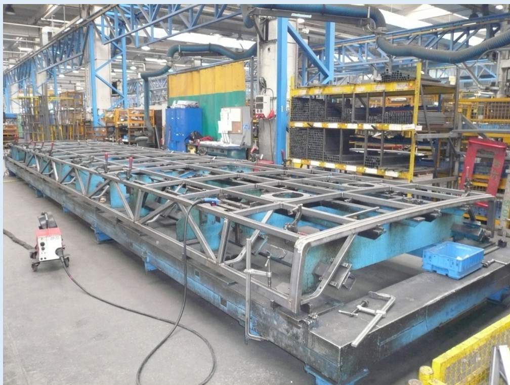
图 2-45 MAN 公交侧围骨架的上部结构
