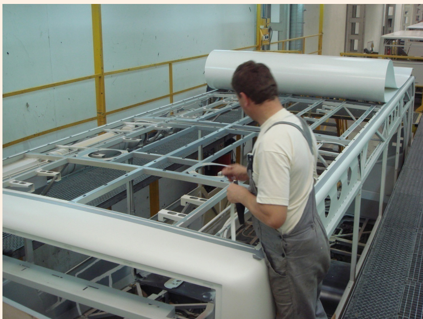
图 3-45 MAN 公交顶蒙皮粘接过程（安装缓冲垫）
