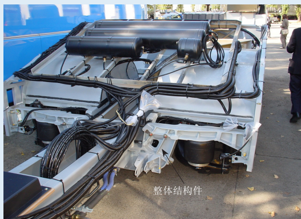
图 2-70 MAN 低地板公交车的结构形式
