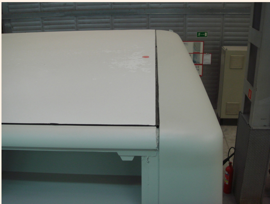
图 3-47 MAN 公交顶蒙皮粘接过程（粘接完成）
