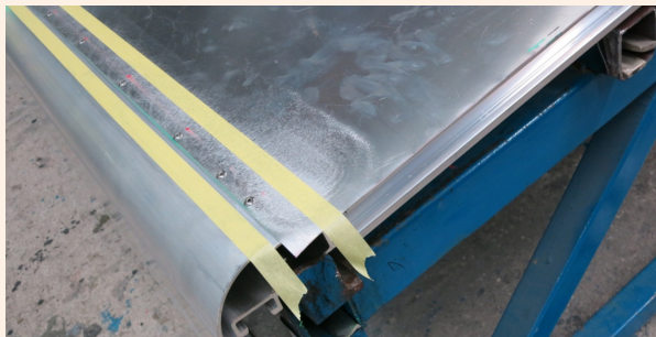
图 3-52 顶盖铝蒙皮的铆接安装结构
