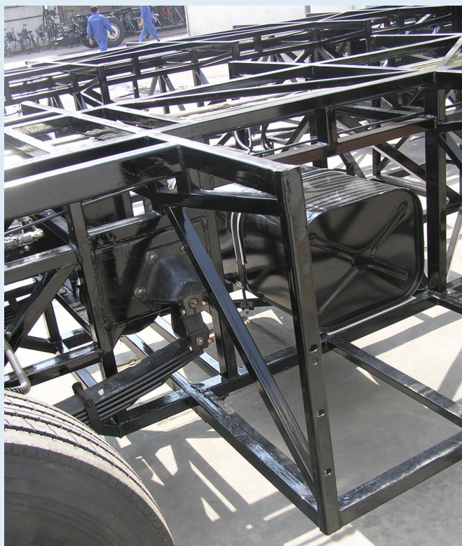
图 2-78 板簧全承载车架的后簧处结构
