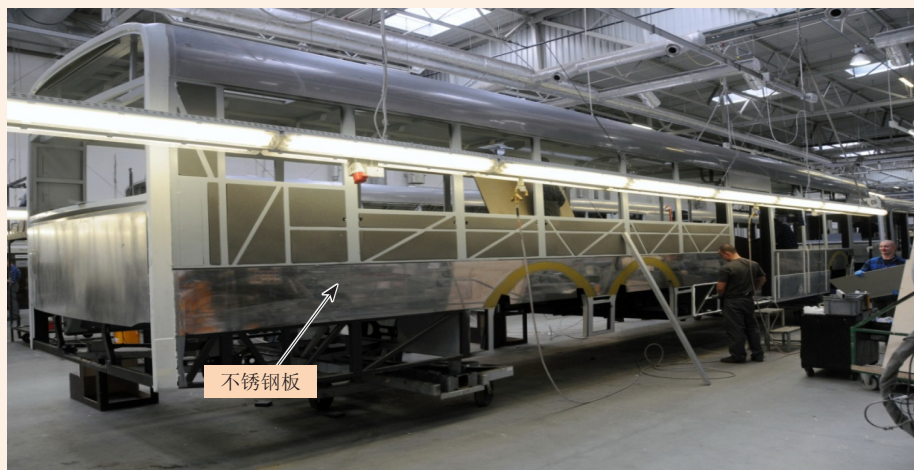
图 3-21 SOLARIS 的公交车侧蒙皮施工现场
