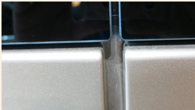
图 3-33 IVECO 的公交车侧蒙皮细节结构
