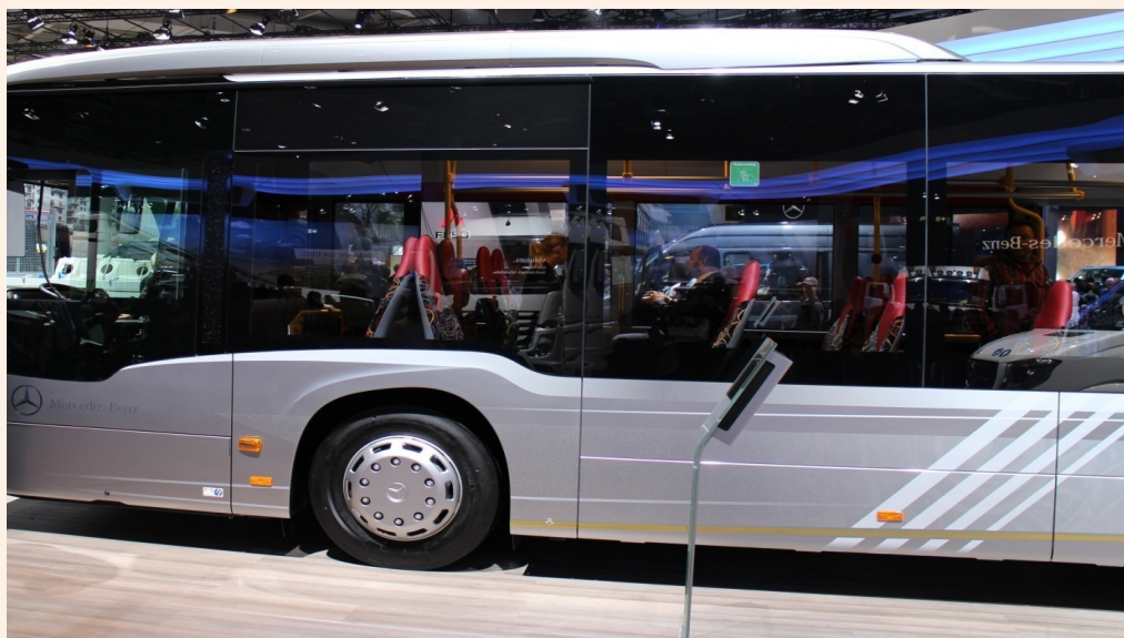
图 3-29 BENZ 的公交车侧蒙皮分段结构（一）
