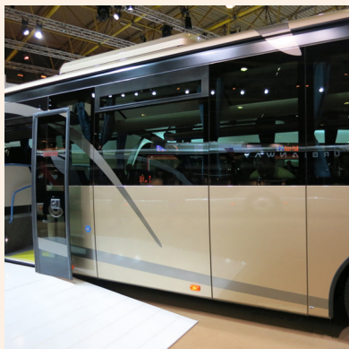
图 3-31 IVECO 的公交车侧蒙皮分段结构（一）
