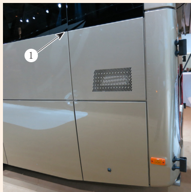
图 3-32 IVECO 的公交车侧蒙皮分段结构（二）
