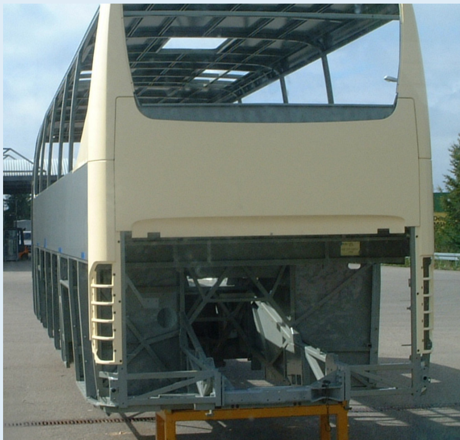
图 2-83 BENZ 的 C 断面连接方式
