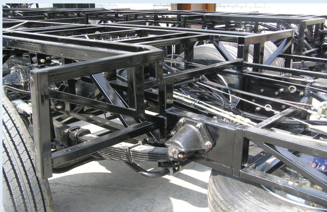
图 2-77 板簧全承载车架的前簧处结构
