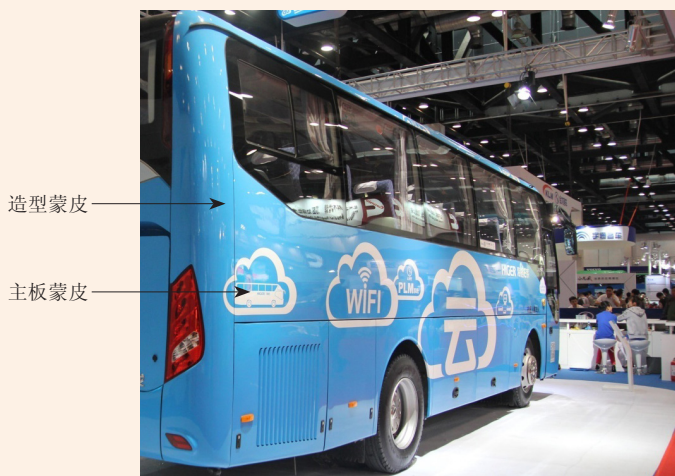
图 3-7 不可取的侧蒙皮结构
