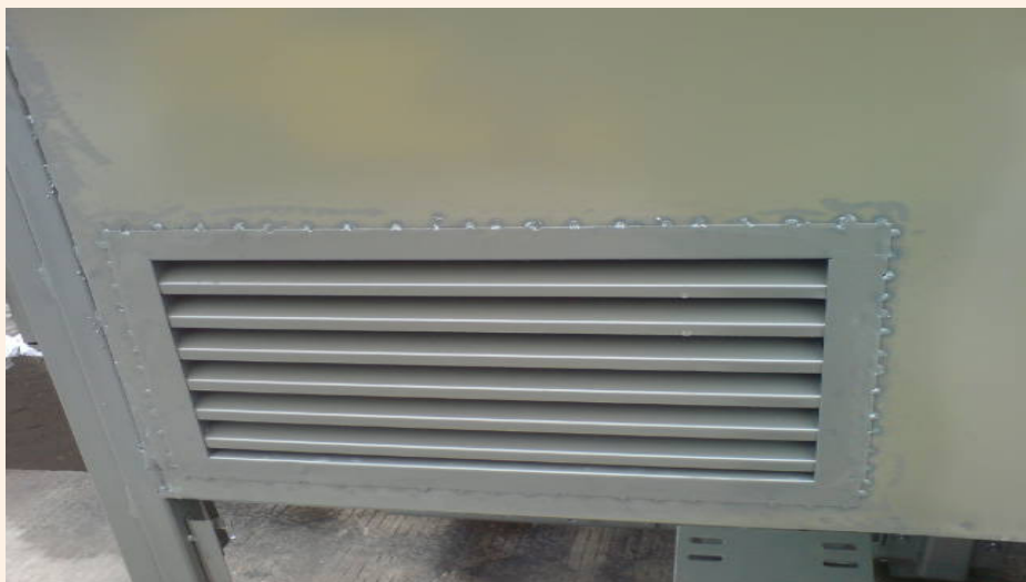
图 3-4 最糟糕的侧进气口的结构形式
