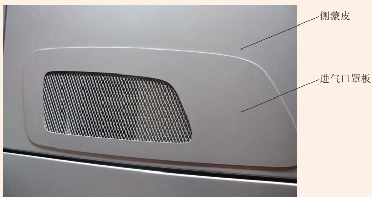
图 3-2 发动机进气口的一种结构形式
