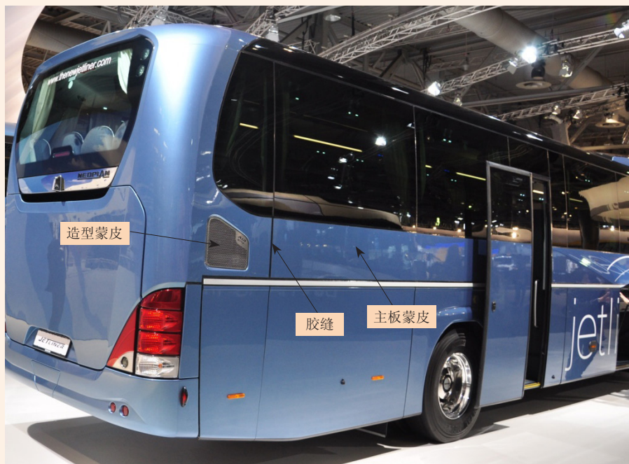
图 3-8 可取的侧蒙皮结构
