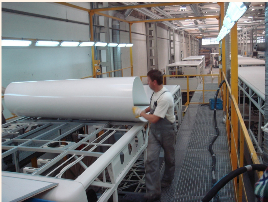
图 3-46 MAN 公交顶蒙皮粘接过程（铺蒙皮板）
