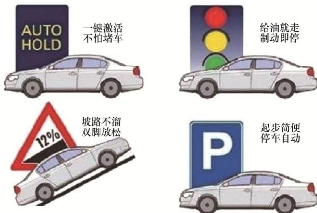
图 11-33 电子驻车制动系统的主要功能
