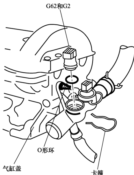
图 4-32 冷却液温度传感器 G62
