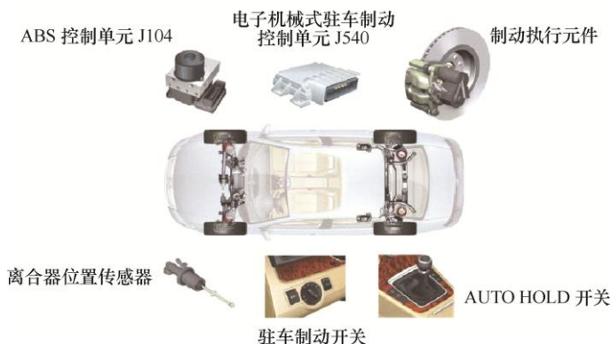
图 11-34 电子驻车制动系统组成
