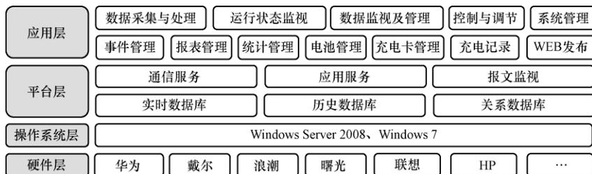
图 7-15 充电站监控管理系统软件架构
