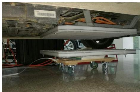
图 4-31 无线充电机整车实车测试图
