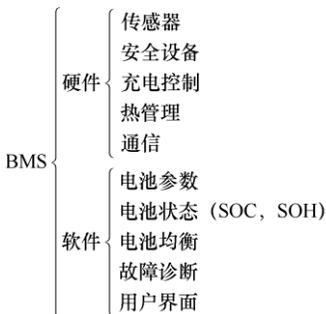
图 2-22 BMS 基础架构
