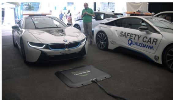
图 1-1 车用无线充电系统 Halo
