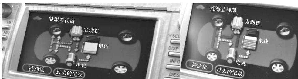
在急加速、高速路或者需要加大转矩的上坡等情况下发动机会及时起动，与电动机同时工作，并且为电池充电
