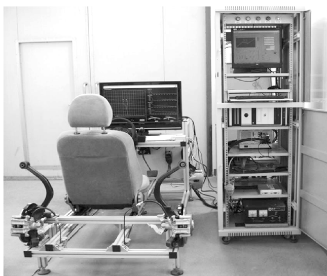
附图 A1 制动能量回收实验模拟台架装置
