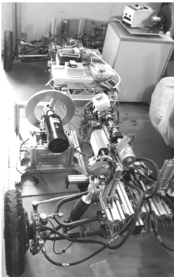
附图 A16 电动汽车能量传输与回收技术整体样车
