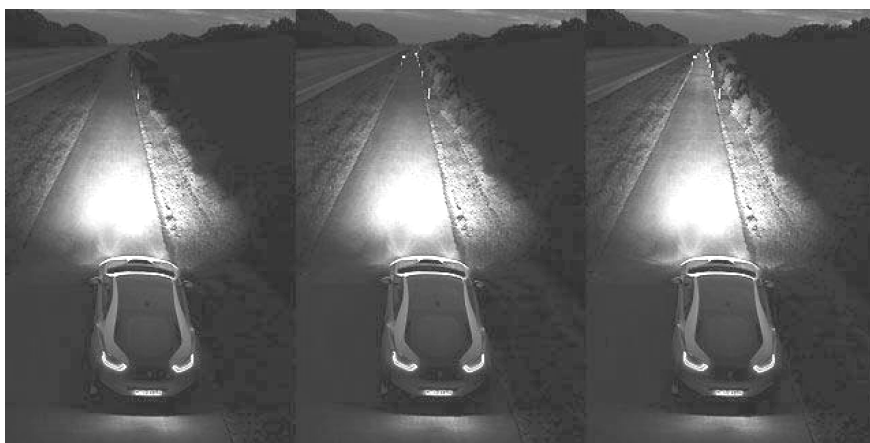
图 1-17 压电能量回收技术驱动照明设备示意图（从左至右，压电能量回收系统分别驱动氙气前照灯、LED 前照灯和激光前照灯的照射距离和效果比较）
