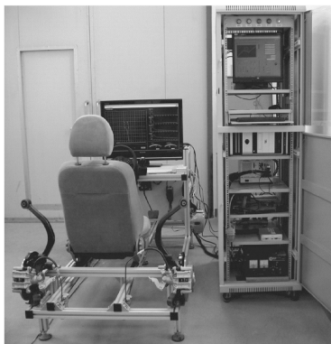
图 3-2 稳控系统混合仿真实验台
