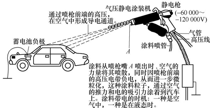
图 5-37 气压静电式涂装机的工作原理
