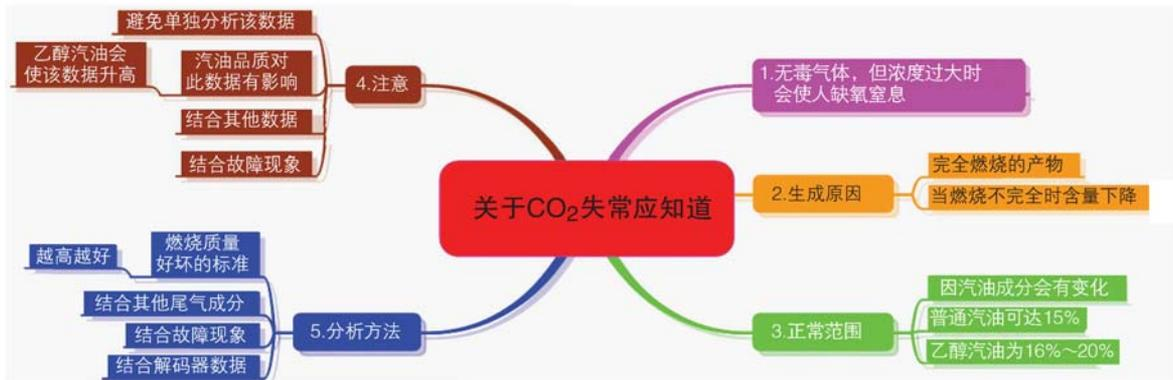
在用尾气分析仪诊断故障时，对于汽油发动机，若尾气中 CO<sub>2</sub> 达到 15% 左右，则说明发动机工作良好。当该数值低于 15%，尤其是小于 13.5% 时，就意味着存在燃烧不良现象，要结合其他数据和检测结果进行综合分析。
