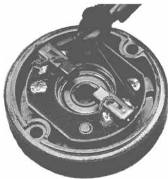
图 5-32 电刷架的结构
