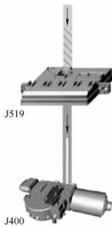
图 6-19 供电控制单元 J519 通过 LIN 总线控制刮水电动机控制单元 J400
