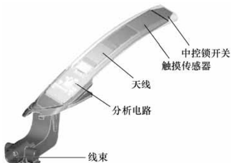
图 9-22 车门把手结构示意图
