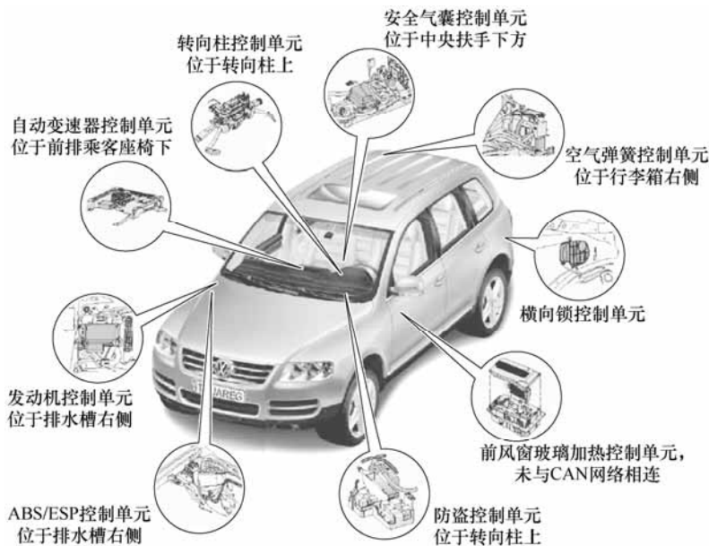
图 1-19 大众途锐动力总线系统控制单元分布示意图
