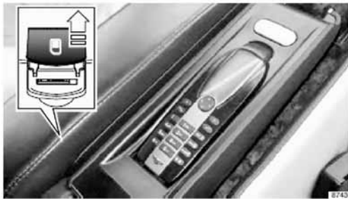
图 11-5 蓝牙 rSAP 电话与 SIM 卡直插式车载电话
