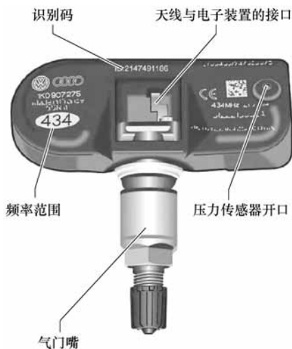
图 6-60 胎压传感器的结构
