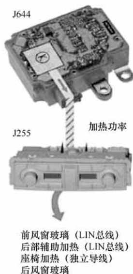
图 5-54 大功率加热系统的调节
