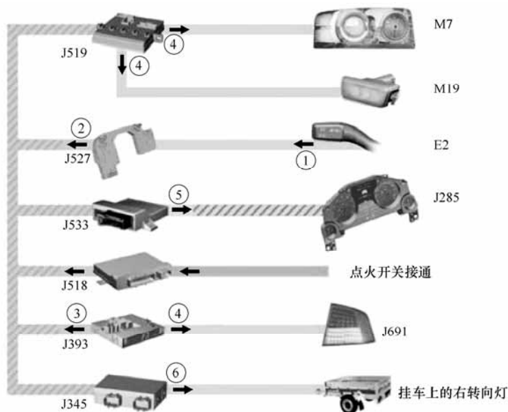
图 6-5 右转向闪光控制过程
