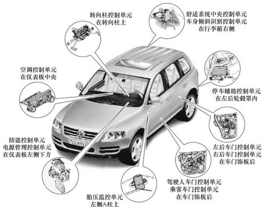
图 1-17 大众途锐舒适系统控制单元分布示意图
