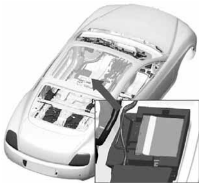
图 9-12 防盗控制单元安装在驾驶人脚坑地毯下方
