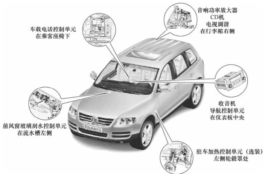
图 1-18 大众途锐信息娱乐系统控制单元分布示意图
