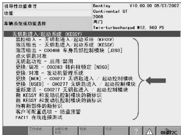
图 9-20 无钥匙进入/启动系统的全部功能
