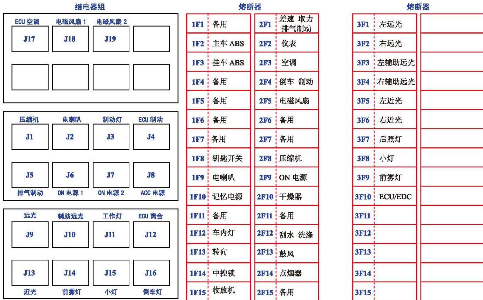
图7-2 德龙新M3000天然气汽车继电器及熔断器盒图
