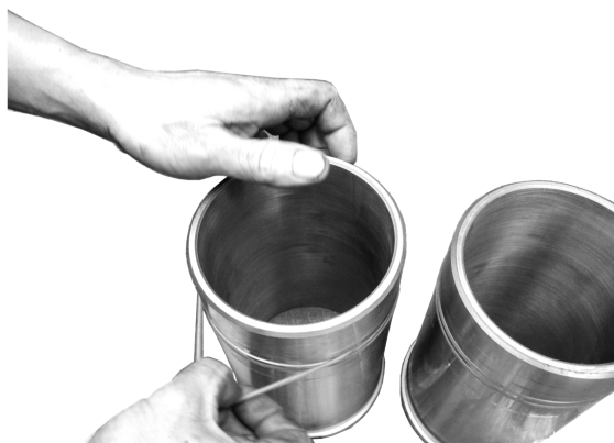
a) 安装气缸套阻水圈
