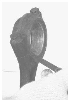
图 8-28 测量轴瓦端面的凸出量
