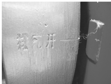
图 14-4 排气门打开时刻，飞轮上的“排气开”刻线与散热器上的刻线对齐
