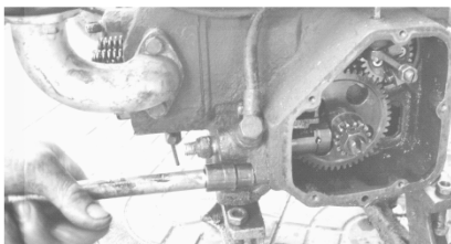
图 13-41 用套筒扳手将 喷油泵固定螺母拧紧
