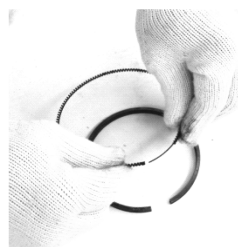
图 1-21 内撑式组合油环的安装
