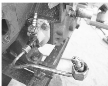
图 14-5 用脉动法来检查 柴油机供油提前角
