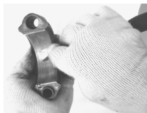
图 8-30 轴瓦的刮削方法
