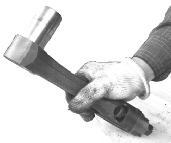
图 13-13 连杆倾斜 45^\circ ， 活塞销能缓慢下落
