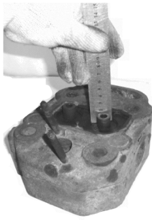
图 9-12 用钢直尺测量气门导管的凸出量
