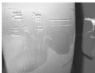
图 14-8 供油时间过迟，飞轮上的 “供油”刻线已越过散热器上的刻线
