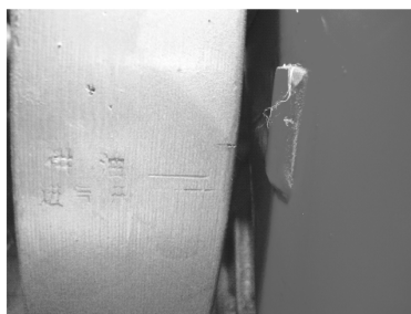
图 14-7 供油时间过早，飞轮上的 “供油”刻线未到散热器上的刻线
