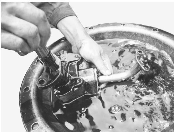
图 13-46 安装机油泵前，检查泵油是否正常
