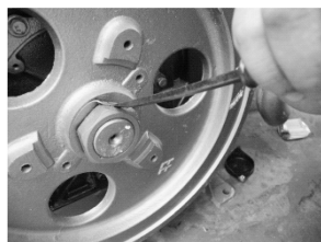
图 6-21 翻开止推垫片 折边的方法
