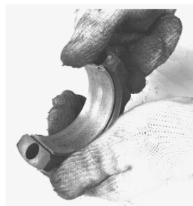
图 8-22 曲轴 连杆轴瓦磨损情况
