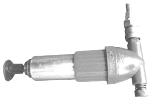
图 2-23 气动气门研磨机
