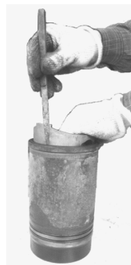
图 7-11 气缸套与活塞裙部间隙的测量
