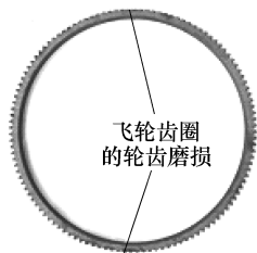
图 8-32 齿圈轮齿磨损
