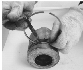
图 8-5 边间隙的测量方法
