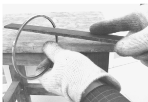
图 8-4 用锉刀修整活塞环开口间隙的方法
