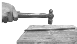
图 9-19 推杆弯曲的冷校直
