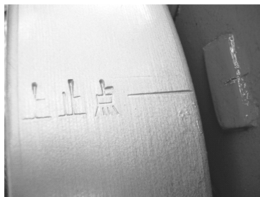
图 14-2 活塞处于上止点位置时，飞轮上的“上止点”刻线与散热器上的刻线对齐
