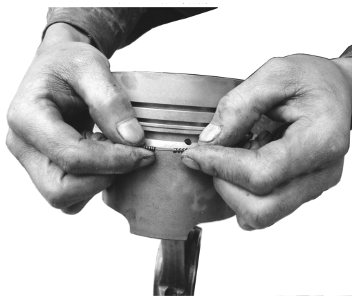
图 13-19 连接撑簧接口的方法
