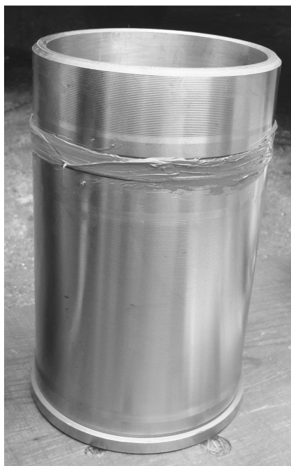
c) 阻水圈涂密封胶后的状态
