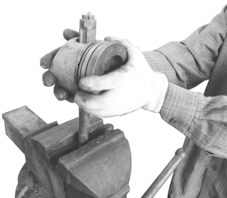
图 13-11 活塞销孔的铰削方法
