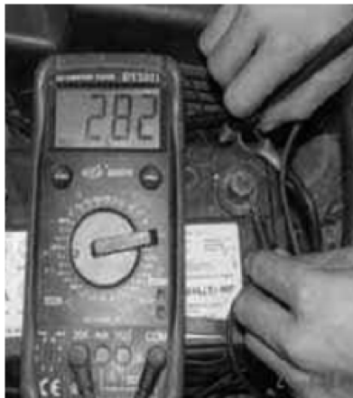
图 4-32 检查蓄电池放电操作
