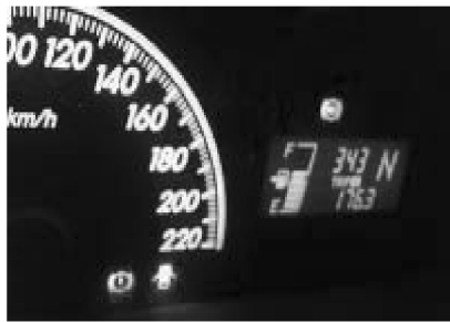
图 5-6 仪表板上的 ABS 故障指示灯点亮
