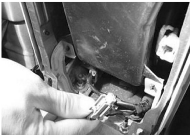
图 11-3 天线的线束插头被压在地板胶下面
