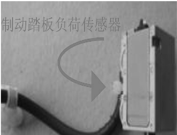
图 5-33 检查测试“制动踏板负荷传感器”
