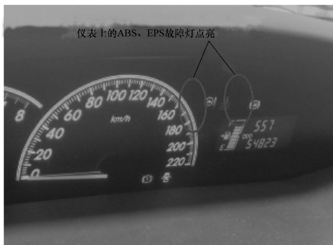
图 5-8 仪表上的 ABS、EPS 故障警告灯长亮
