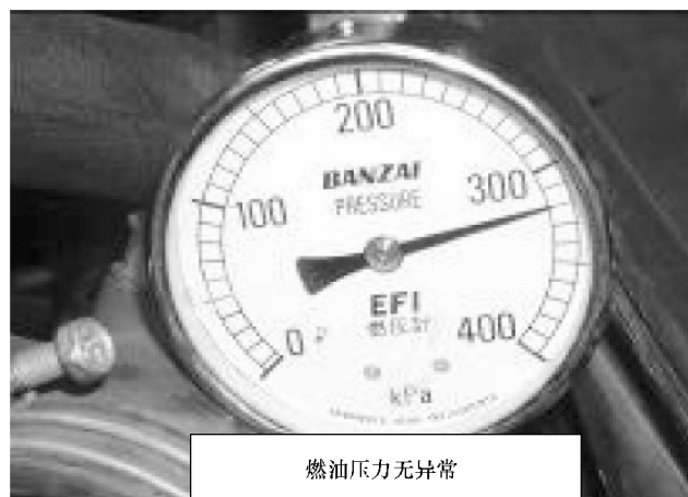
图 5-12 检查燃油压力为 320kPa
