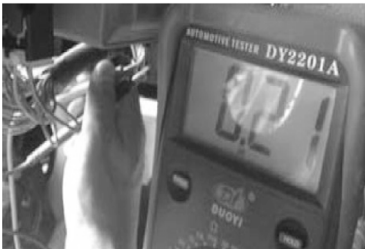
图 5-19 端子 E51-3—E51-1 在点火开关 OFF 并开左门时电压为 0.21V
