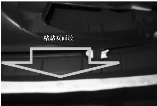
图 5-5 把仪表台前端边缘处垫上一层双面胶
