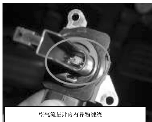
图 5-13 流量计内的发热丝有异物缠绕
