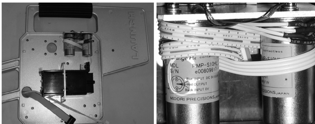
图 3-8 电子式重力倾角传感器
