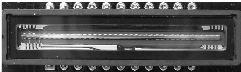
图 3-9 CCD 电荷耦合器件
