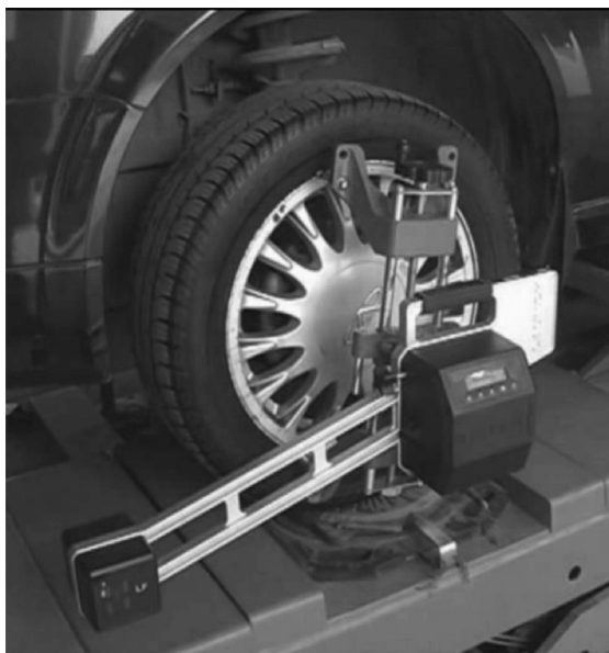
图 3-3 探杆在车轮上的安装
