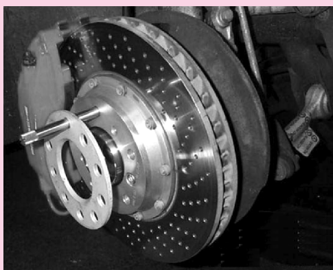
图 2-62 车轮安装定位销
