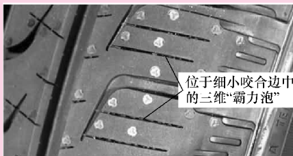
图 2-42 固特异御乘 SUV 轮胎 “三维霸力泡”设计
