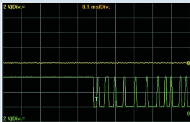
示意图：CAN-High 线与 CAN-Low 线装混了。
