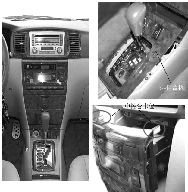
图 5-9 拆卸装饰面板
