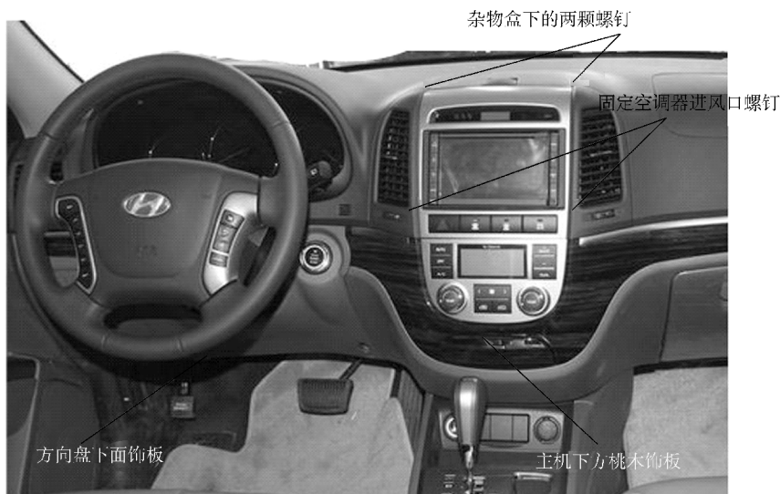
图 5-15 现代 - 新胜达汽车音响的拆卸
