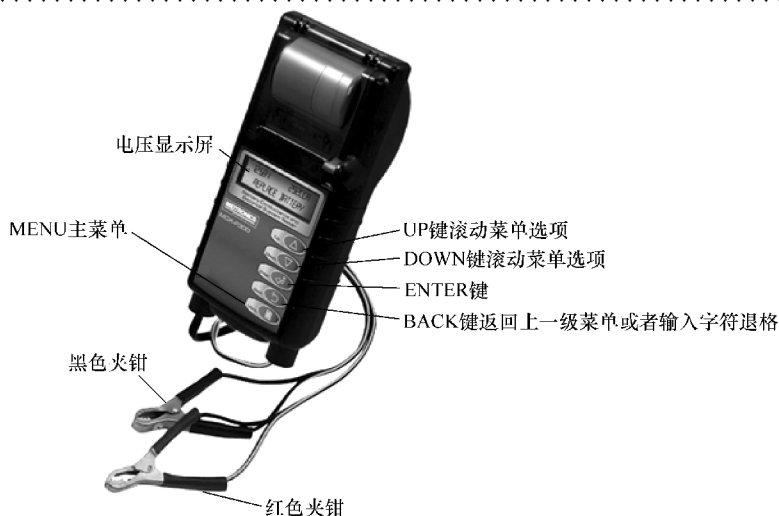
图 3-5 蓄电池专用检测仪结构
