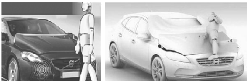
图 1-43 行人安全保护系统工作过程
