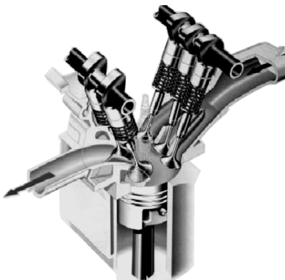
图 1-5 3 进 2 排的 5 气门发动机
