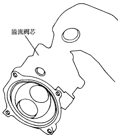
图 10-51 从储液器控制阀组 上取溢流阀芯
