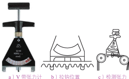
图 3-13 用 V 带张力计测量 V 带的张力
