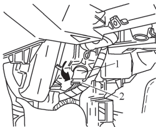
图 5-25 拆卸蒸发器出风口温度传感器 G263
