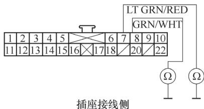
图 5-106 检查前面板总成 22P 插接器的 7、8 号端子与车身搭铁之间的导通性
