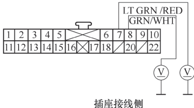
图 5-107 检查前面板总成 22P 插接器的 7、8 号端子与车身搭铁之间的电压
