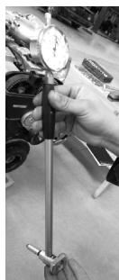
图 2-5 量缸表的 正确拿法
