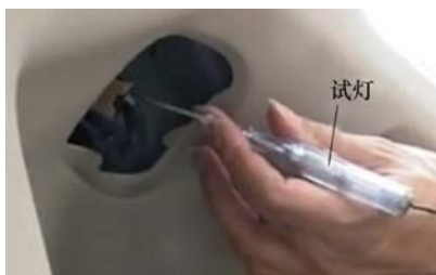
图 7-27 用试灯查找倒车灯电源导线
