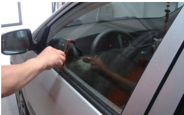
图 6-13 侧窗窗膜压刮定型
