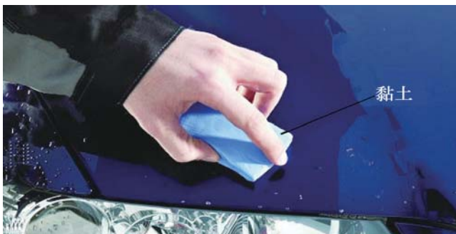
图 4-20 用“去污黏土”对车身进行打磨处理
