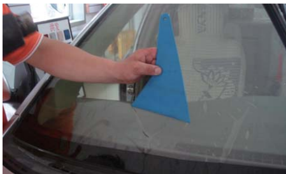
图 6-16 排除“气泡”和安装液
