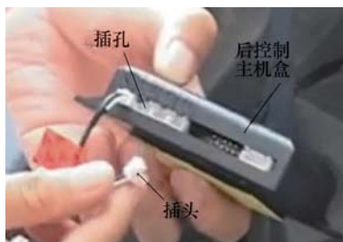
图 7-29 连接传感器与后控制主机盒
