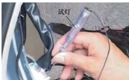
图 7-33 找到行车灯电源线
