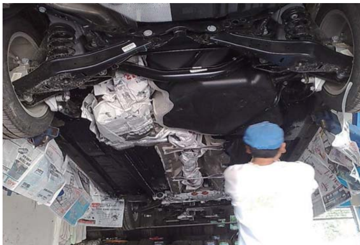
图 7-8 用报纸密封、贴护
