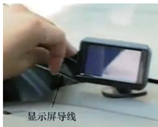
图 7-32 整理显示屏导线
