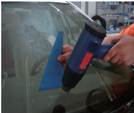
图 6-17 前风窗玻璃贴膜的热成型
