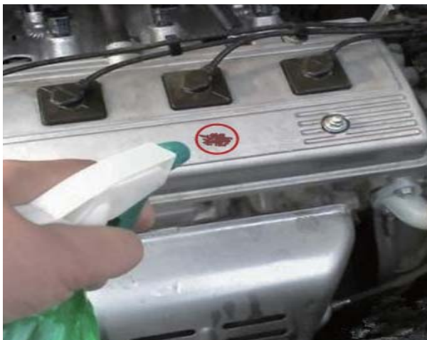
图 3-10 用除锈剂喷在锈斑处
