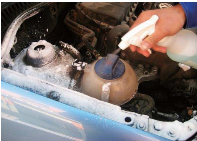
图 3-7 喷洒清洗剂在发动机舱内油污处
