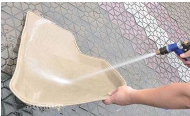
图 2-17 用高压水枪冲洗脚垫
