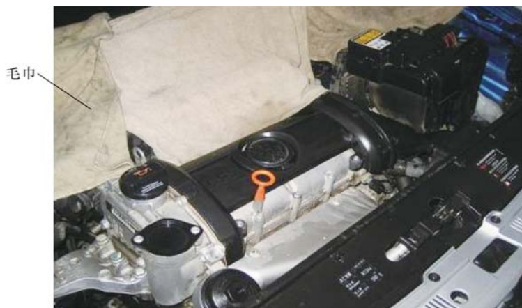
图 3-6 遮盖高压线、电路线路等电器部位
