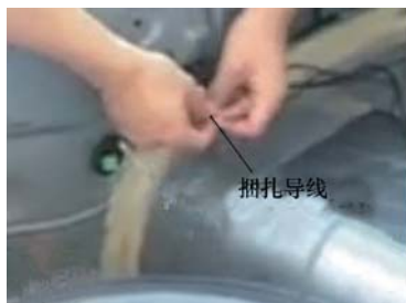
图 7-26 捆扎传感器导线
