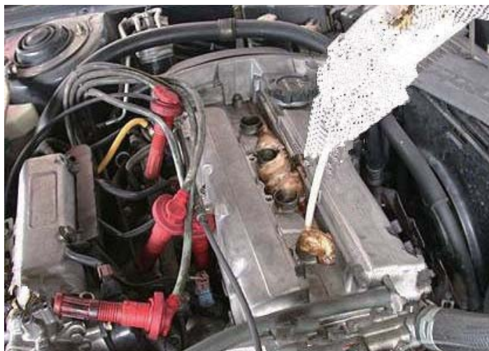
图 3-11 用压缩空气吹掉灰尘
