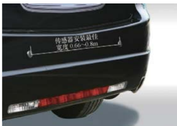
图 7-37 传感器（探头）安装宽度
