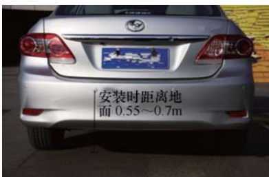
图 7-38 传感器（探头）安装离地距离
