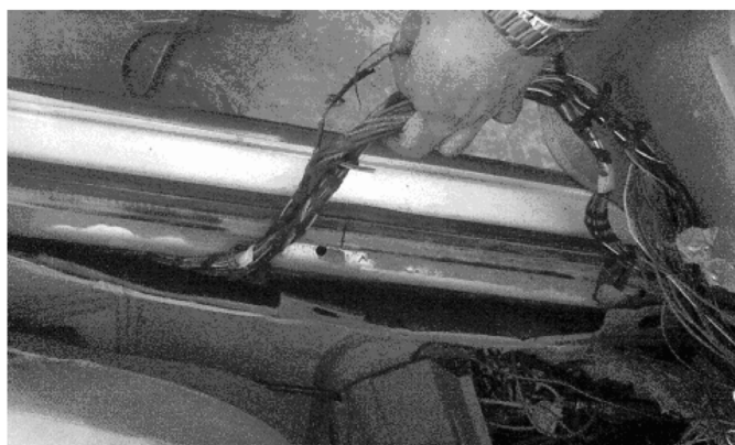
图 3-8 捷达电动车窗线束被腐蚀的地方——左前门脚踏板下方
