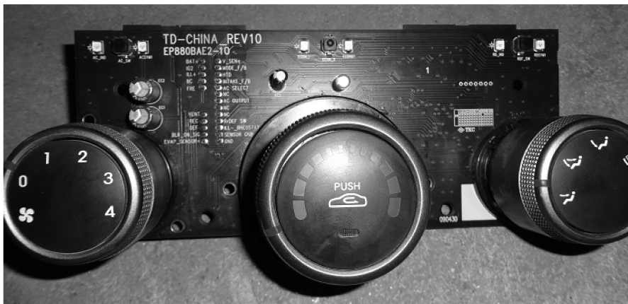
图 2-14 空调操作面板
