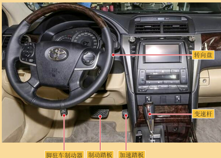
自动档车汽车驾驶操纵装置
