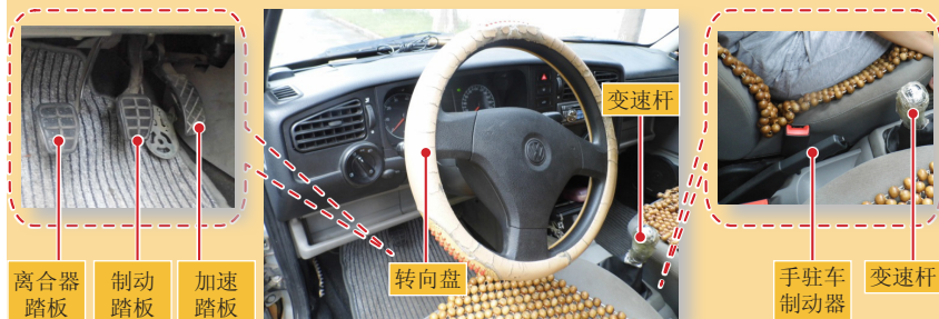
手动档车汽车驾驶操纵装置
