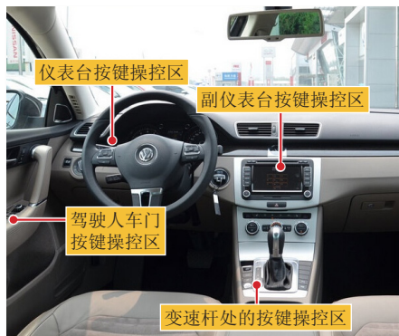
汽车常用功能的按钮和开关的区域布置
