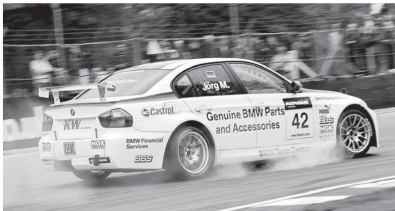
**图 7-1** 极限驾驶技术的一个重要方面就是要控制好制动，使轮胎保持在抱死之前的临界状态，就像图片中的内侧前轮那样。偶尔出现这样的轮胎稍稍抱死没有关系——尤其是此时抱死的是空载的内侧轮胎。但是如果有一个以上的轮胎抱死，就说明必须要稍稍松一点制动踏板了
