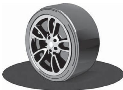
图5-4 轮胎接触面是指在旋转时与赛道表面接触的轮胎面积
