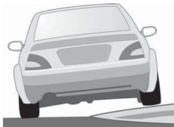
**图12-3** 对于有些赛车，使用内侧轮胎压过路缘有助于增大外侧轮胎的载荷，增加外侧抓地力。当然，这取决于路缘的大小和形状。此外，在路缘上行驶通常能让弯道更直，增大弯道半径
