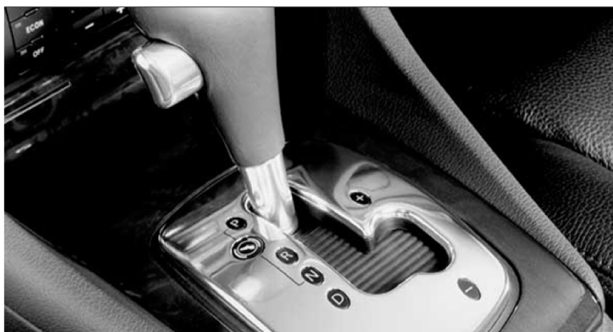
图 3-5 自动变速器的档位
