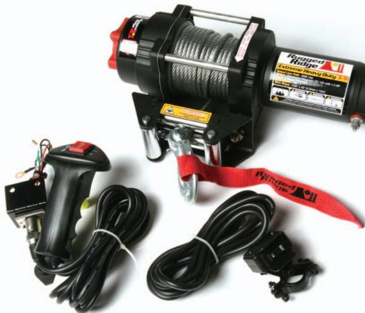
一般车队长途越野旅行时，队内起码要有三辆车装有绞盘，因为在恶劣的自然环境下最少要有三个绞盘才可以运作自如。如果达不到这个要求，那么也不必着急，可以事先在车队每辆车的前后保险杠都安装一个方形接口，这是国际上越野车通用的口径。只要把绞盘插到这个接口上，就能够完成救援，这就是很多车队中常见的快装式绞盘。采用快装式绞盘不但可以节约使用成本，而且对于那些平时并不需安装绞盘的车辆来说还可以降低不少油耗，另外通用接口还可以做插接拖车之用。
