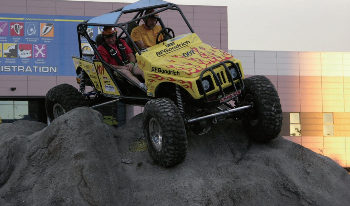
量发动机经过专门的调校后，低转速大转矩的特性就让车辆在攀越岩石时显得更加从容自如。此外，其他一些如前后轮分别制动、前后轮分别转向、差速器锁的设计以及几乎占到车身一半、胎面粗而深、扁平比巨大的“大脚”轮胎的使用更加提升了攀岩时的性能。
