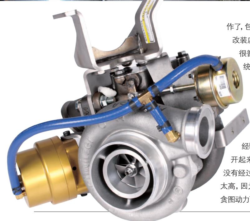
作了,包括“排气芭蕉”的焊接和弯管等步骤都需要改装店来自行设计制造,不过现在安装涡轮已经是很普遍的事了,很多改装店都可以制作,但整套系统中最复杂的问题就是ECU的调校了。
