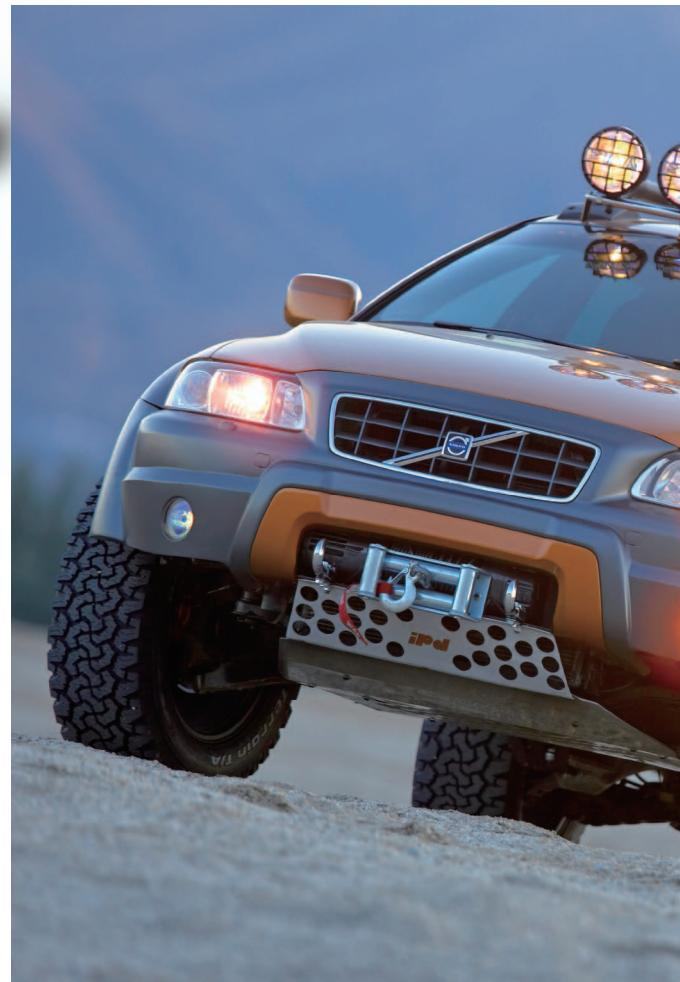
容易损坏安全气囊的感应器。如果你打算安装绞盘，应该确信为你安装的人了解潜在的安全气囊问题。其次就是要确定车辆的蓄电池能否足以应付你新安的绞盘。大绞盘需要耗费很多电，在只有一个蓄电池的情况下，较长时间的使用绞盘很容易会将电耗尽。应该安装更大的发电机或双蓄电池系统，或者两者同时安装。
