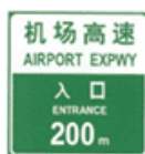
入口预告 200m前预告高速公路入口
