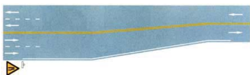
四车道缩减为双车道
