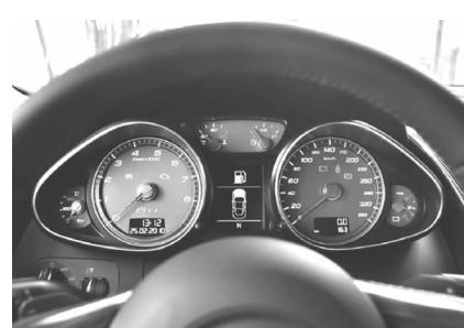
图1-12 汽车电子组合仪表
