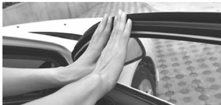
图 1-35 检查车门密封条
