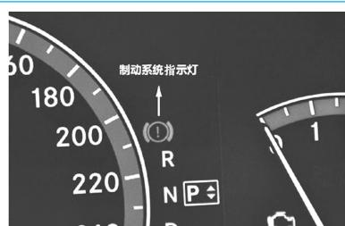
图3-48 制动系统指示灯点亮
