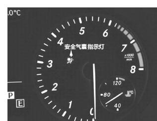
图 3-54 安全气囊指示灯点亮
