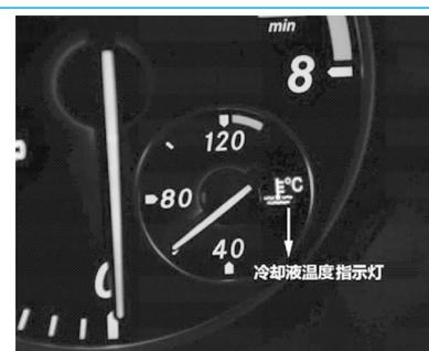
图3-46 冷却液温度指示灯点亮
