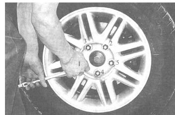
图 2-31 轮胎螺柱拧紧顺序
