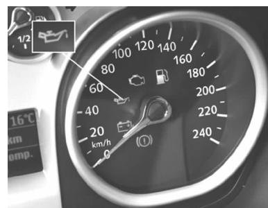
图 3-45 机油压力指示灯点亮
