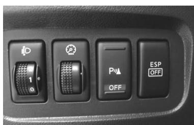
图 3-16 中控台上的 ESP 开关
