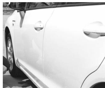
图1-31 车门缝隙检查
