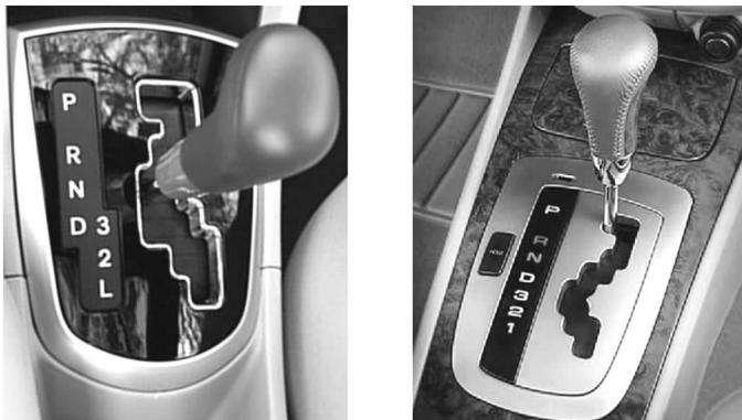
图3-20 自动变速器汽车变速杆位置排列
