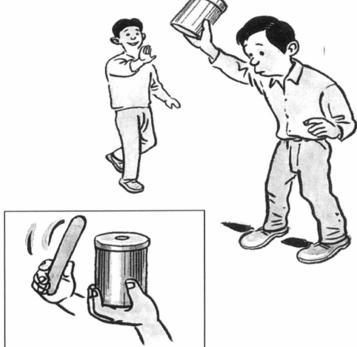
图 3-18 空气滤清器的维护
