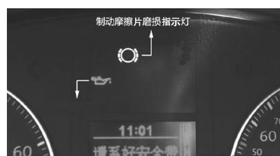
图3-52 制动摩擦片磨损指示灯闪亮
