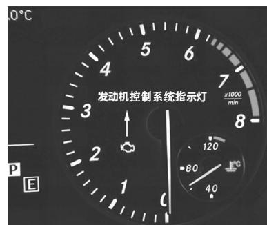
图3-51 发动机控制系统指示灯点亮
