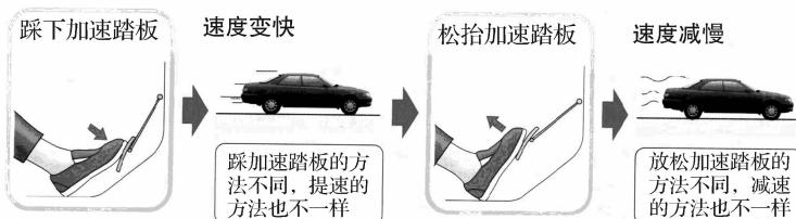
图3-9 加速踏板提速、减速调节
