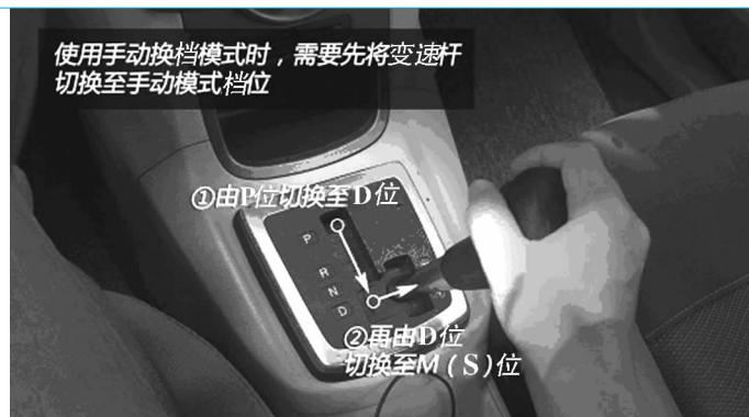
图 3-23 手自一体变速器切换到手动模式
