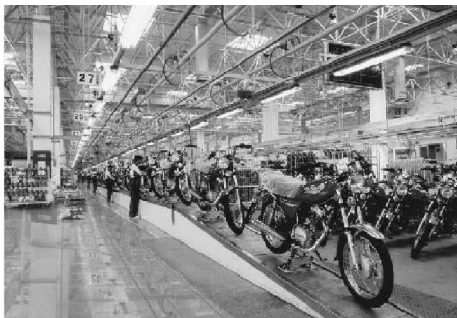
图 2-25 摩托车装配线
