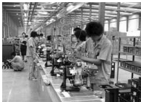
图 2-24 摩托车发动机的生产流水线
