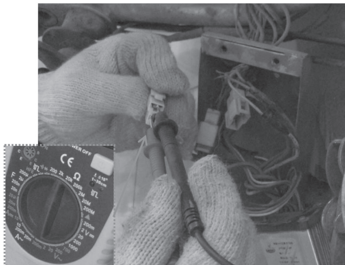
图 7-38 用 R \times 1 挡测量电动机与控制器间的电阻
