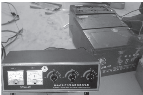
图 5-11 用充电器恒流充电
