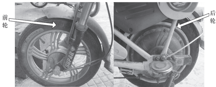
图8-41 转动电动自行车前后轮
