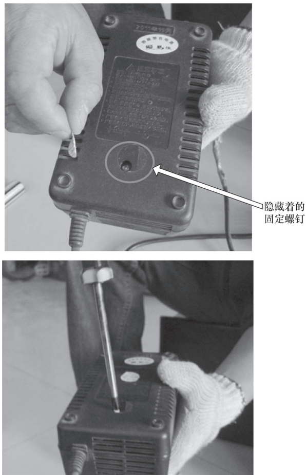
图 4-3 拆开固定螺栓
