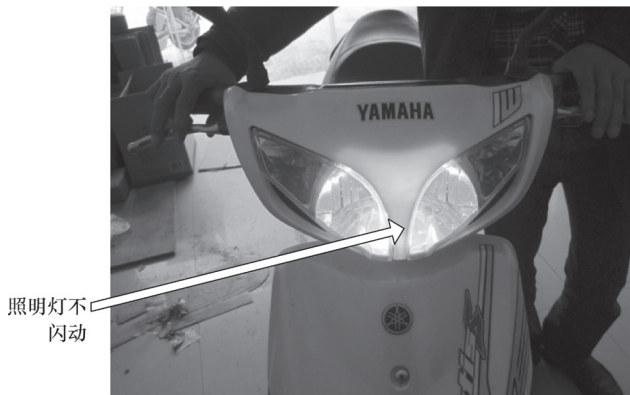
图 8-43 打开照明灯检查
