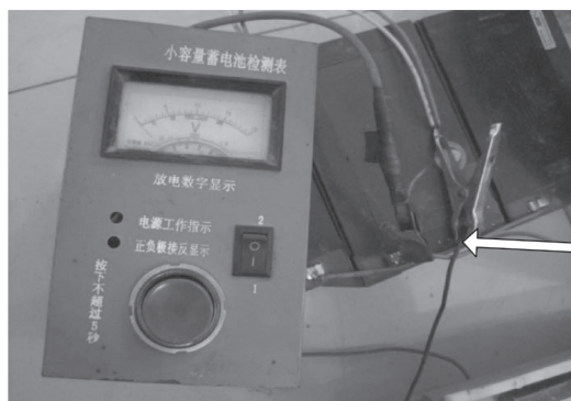
图 5-16 观察蓄电池检测仪指针
