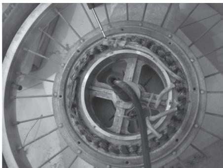
图 8-12 检查电动机控制线路
