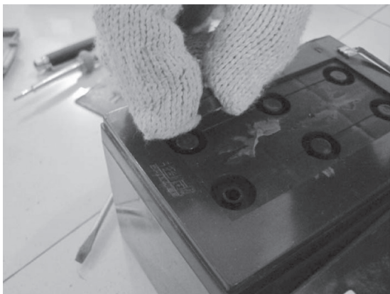
图 5-17 拔下蓄电池电池盖
