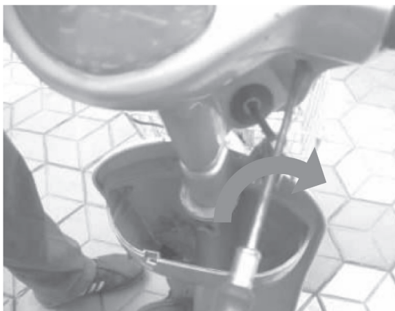
a) 用十字螺钉旋具打开前头罩
