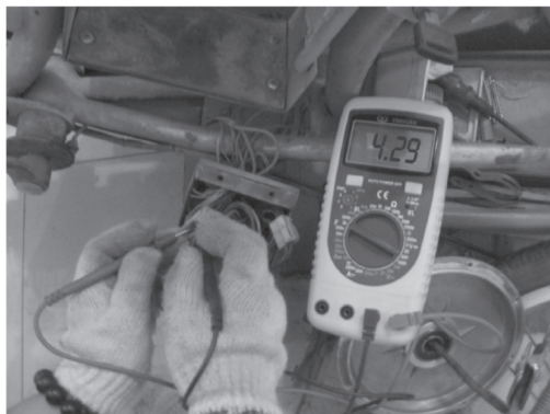
图 8-37 测量闸把开关电源电压
