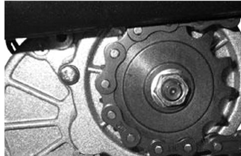
图 2-58 电动车飞轮示意图
