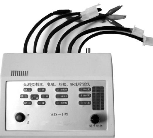
图 2-30 电动车综合检测仪外形实物
