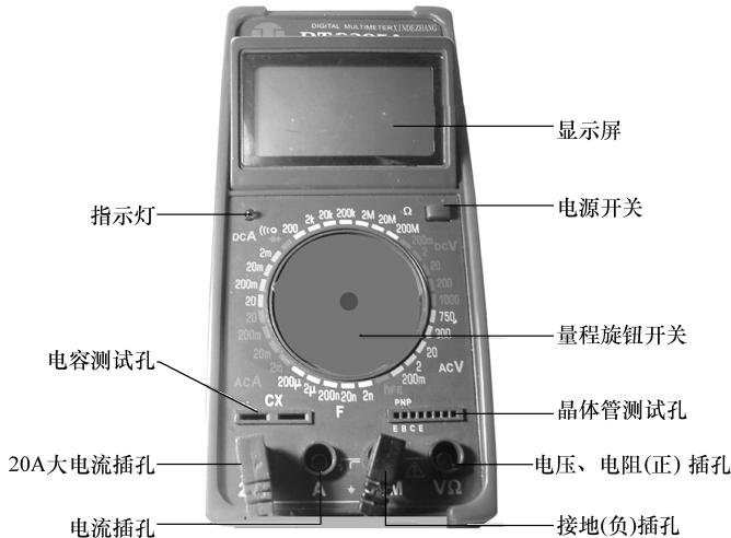
图 2-14 DT9205A 型数字万用表外形实物及面板功能键
