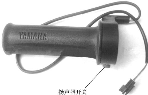
图 3-85 雅马哈品牌美骑士电动车扬声器开关外形实物
