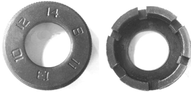
图 2-44 辐条扳手外形实物
