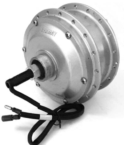
图 3-83 雅马哈品牌凌燕 36V 有刷有齿电动车专用电动机外形实物
