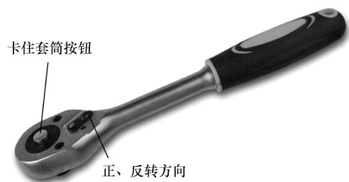
图 2-11 棘轮扳手实物结构
