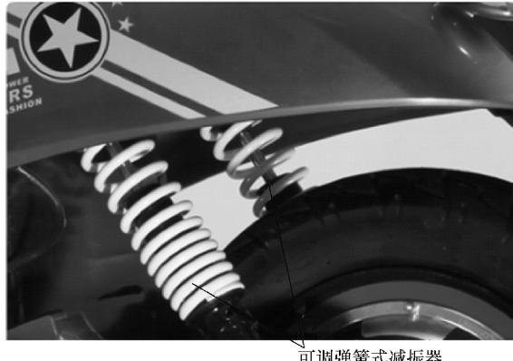
图 1-10 电动车后减振器
