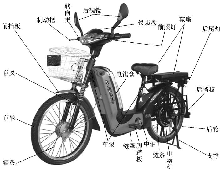
图 1-136 某电动车车体结构部件名称
