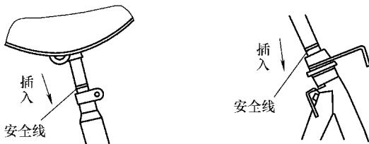
图 2-80 调整电动车的鞍座及车把的高度示意图
