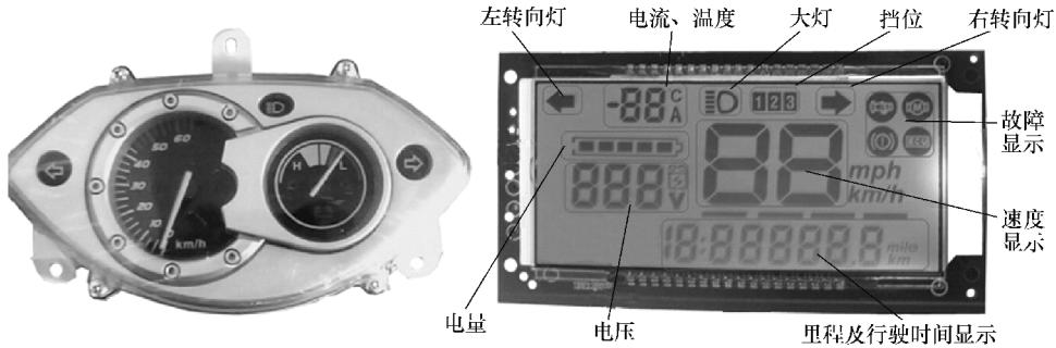
图 1-56 指针型和液晶显示仪表外形实物
