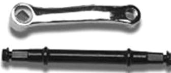
图 2-60 拆卸中轴和右侧的轴碗组件
