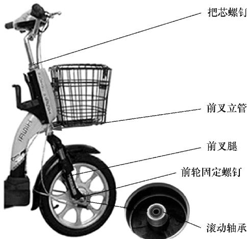
图 2-74 电动车前轮出现偏转故障部位示意图
