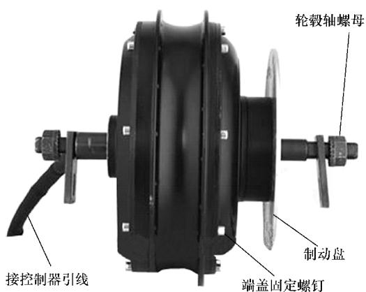
图 2-46 拆卸电动机方法图
