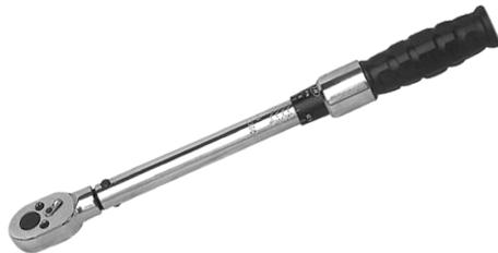
图 2-12 指示式扭力扳手外形实物
