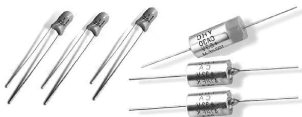
图 1-111 常见的两种钽电解电容外形实物
