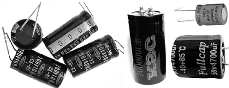
图 1-105 常见的铝电解电容外形实物
