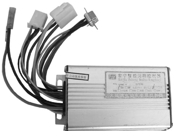
图 3-17 大陆鸽品牌电动车专用控制器外形实物
