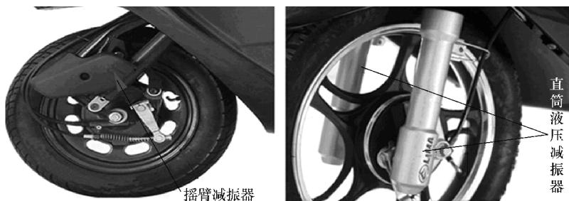
图 1-9 电动车上的两种前减振器
