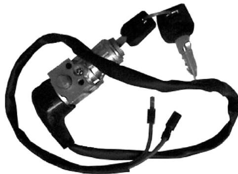
图 3-28 捷安特品牌电动车专用电门锁外形实物
