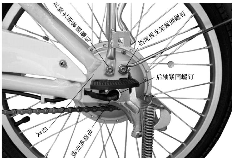
图 2-83 电动轮毂外部紧固件示意图
