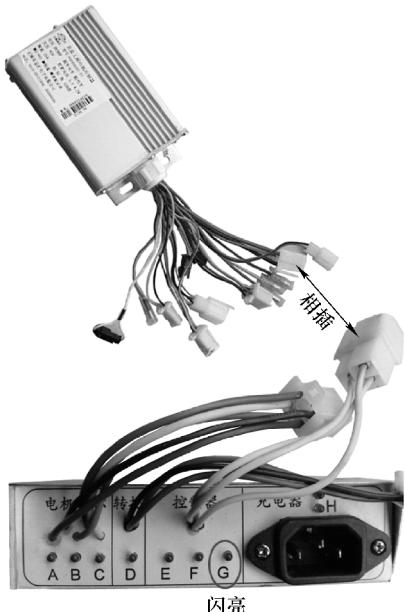
图3-56 使用电动车检测仪检测控制器性能示意图
