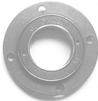
图 1-22 电动车无齿飞轮
