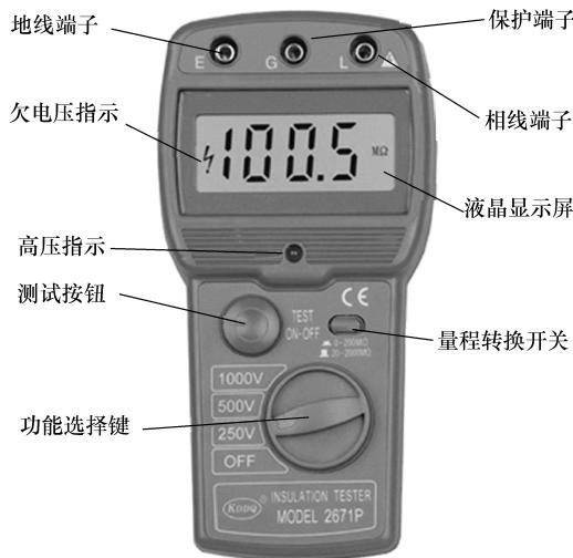
图2-17 2671P型数字绝缘电阻表外形实物及面板功能键
