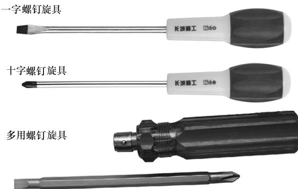
图 2-1 手动螺钉旋具外形实物
