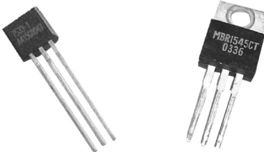
图 3-47 千鹤品牌奥通 200 型豪华款电动车控制器主电路板 7533 和 1545 外形实物
