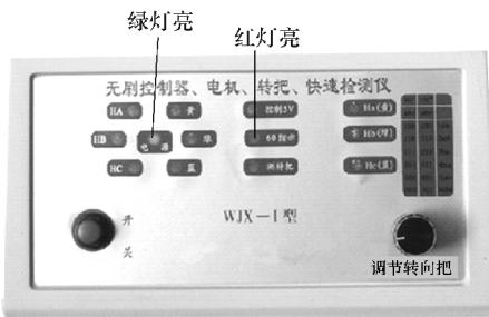
图 2-35 检测无刷电动机为  $60^\circ$  相位角状态
