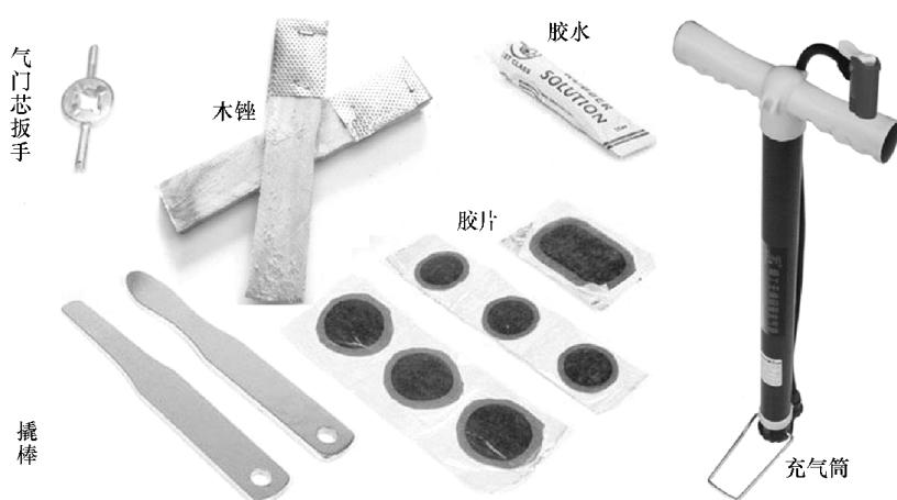
图 2-42 电动车补胎工具外形实物
