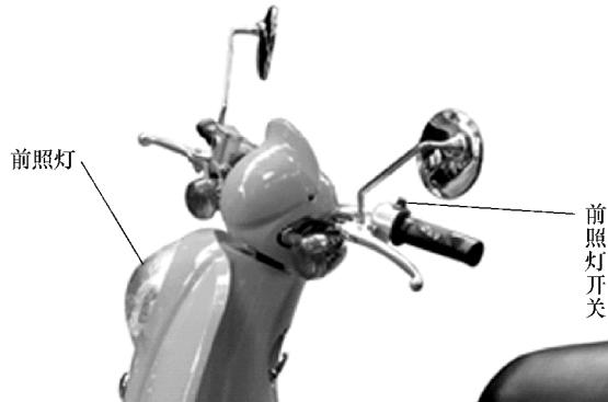
图 3-10 本太郎品牌电动车前照灯及前照灯开关外形实物
