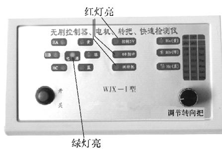
图 2-34 检测电动机霍尔元件状态
