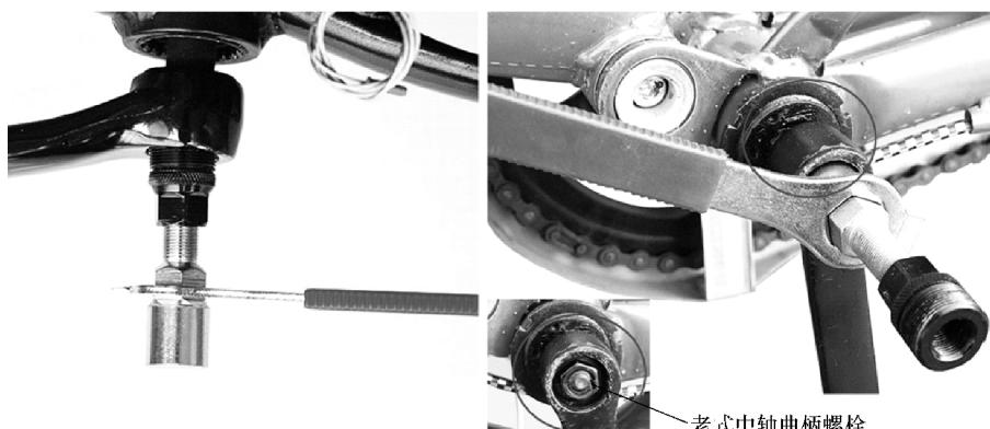
图 2-38 曲柄快拆器使用方法示意图
