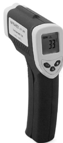
图2-78 非接触式红外线
