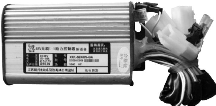
图 3-65 新日品牌电动车专用控制器外形实物
