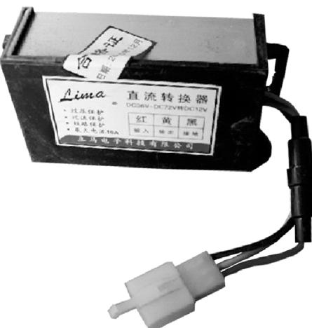
图 3-34 立马品牌电动车转换器外形实物
