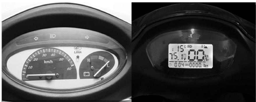
图 1-11 指针型和液晶显示型仪表外形实物
