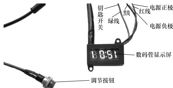
图 1-156 数码管外形实物结构
