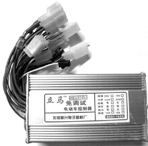
图 3-32 立马品牌电动车控制器外形实物
