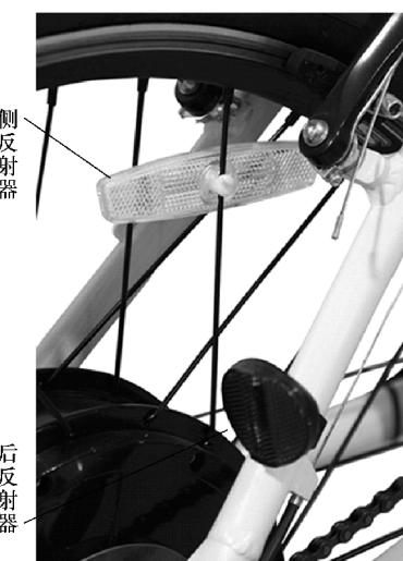
图2-82 电动车反射器装配位置示意图
