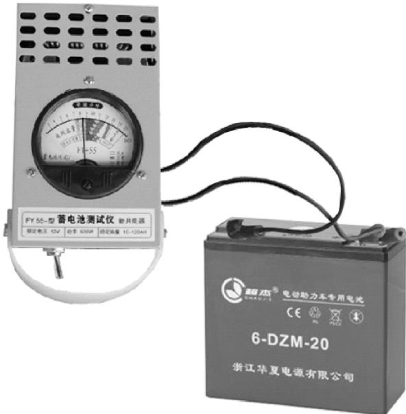
图3-57 使用蓄电池检测仪检测蓄电池性能示意图
