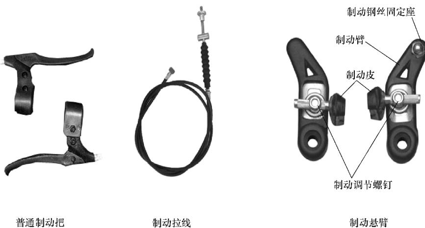
图 1-23 普通电动车制动组件
