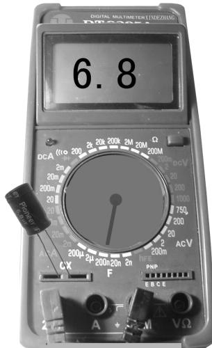
图 2-15 使用数字万用表测量电容
