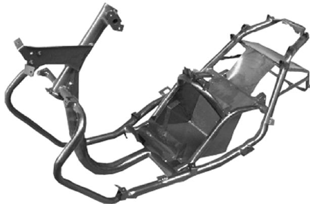
图 1-17 电动车车架实物
