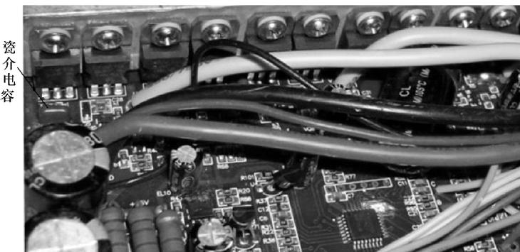
图 1-114 某电动车控制器上的瓷介电容
