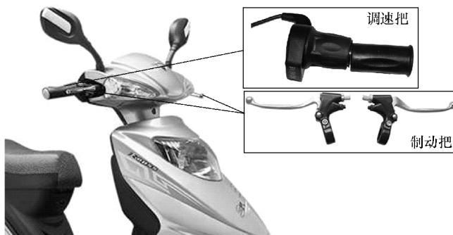
图 1-14 电动车制动把和调速把外形实物
