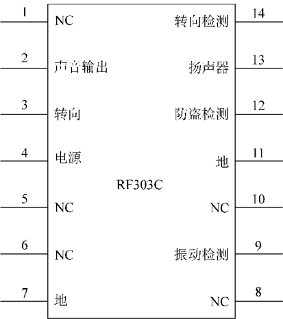
图 2 - 36 电动车报警扬声器专用芯片 RF303C 引脚排列图
