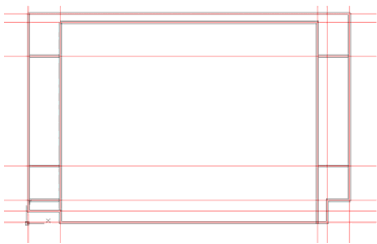
图 15-6 绘制建筑轮廓线
